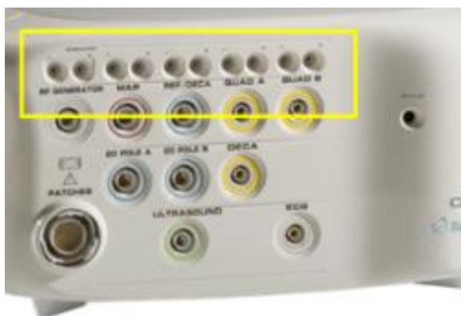
Рисунок 5: Разъемы PIU для подключения кардиостимулятора
