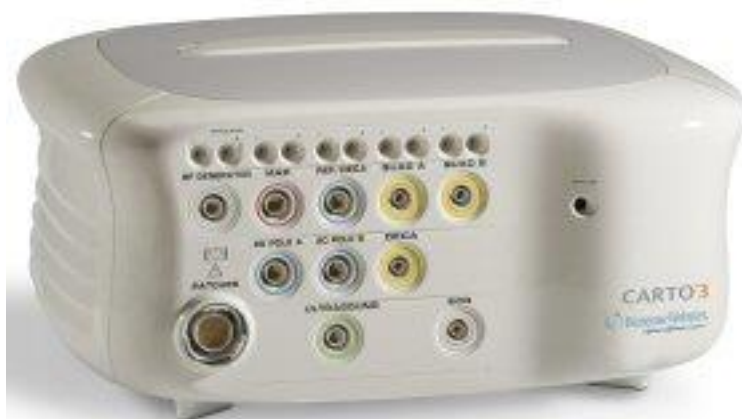
Рисунок 2: Интерфейсный блок (PIU), передняя панель
