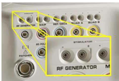
Рисунок 6: Пара стандартных (с локальным направлением импульса) разъемов для кардиостимуляции
