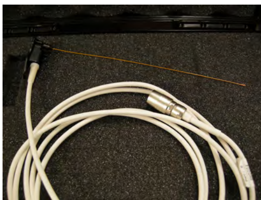
Рис. 13-154. Сенсор кончика иглы с кабелем: вид вблизи
