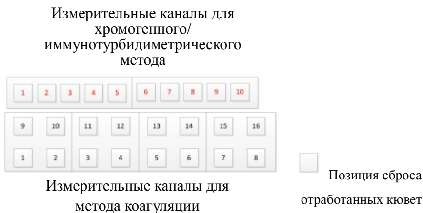
Рисунок 1-6. Измерительные позиции блока измерения. Вид сверху.
