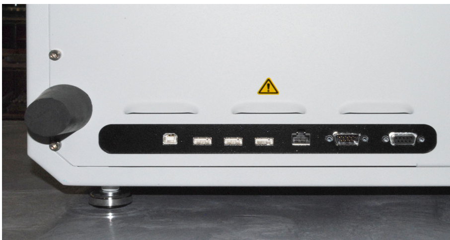
Рис. 1-4 — Разъемы на задней панели прибора (внизу слева)
