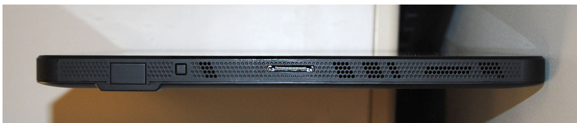
Рис. 1-8 — Разъемы на планшетном ПК (снизу)
