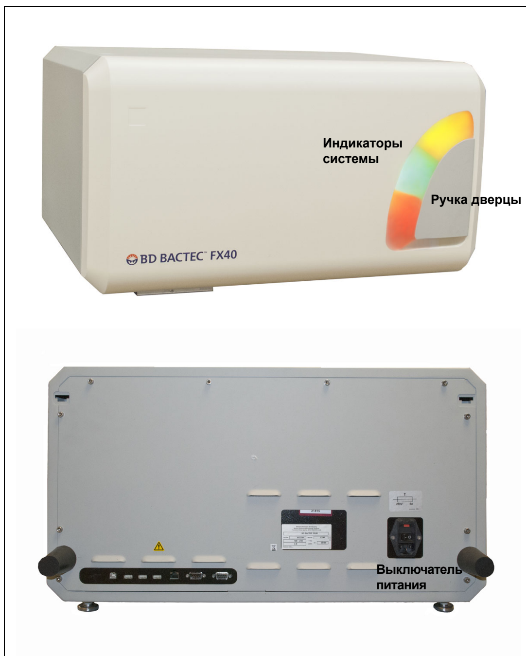
Рис. 3-1 – Внешние элементы управления и индикаторы прибора BD BACTEC™ FX40
