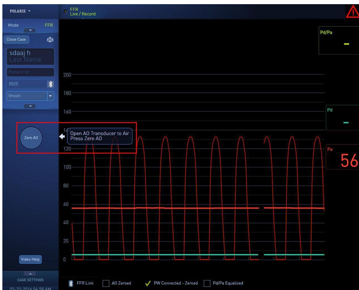
Рисунок 2-15: Сообщение «Открыть преобразователь АО давления в давление воздуха»
