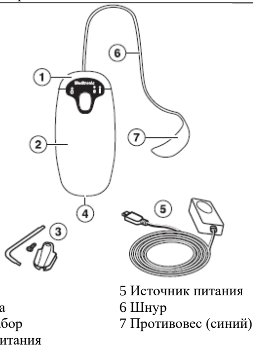
Рисунок 1. Компоненты коннектора для пациента
