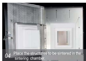
04 – Расположение структуры, которая спекается, в камере спекания
