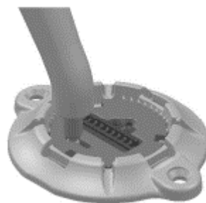
Рисунок 41. Введение инструмента для установки/удаления
