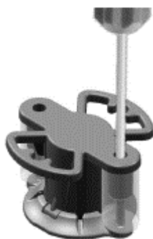
Рисунок 7. Основание зафиксировано в инструменте для фиксации типа «бабочка» со вставленной отверткой
