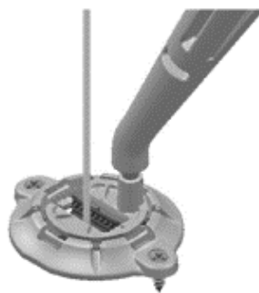
Рисунок 20. Расположите фиксирующую клипсу над основанием
