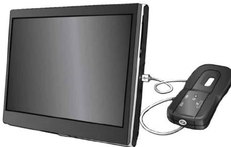
Рисунок 5. Vercise PC и Vercise Gevia: клинический программатор (КП) и программирующая головка
