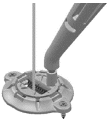
Рисунок 15. Расположите фиксирующую клипсу над основанием
