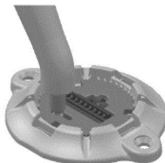
Рисунок 31. Введение инструмента для установки/удаления
