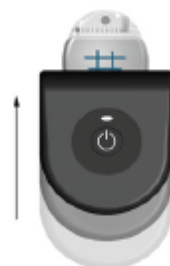
Рисунок 10. Выравнивание зарядного устройства по нижнему краю
