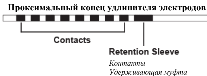
Рисунок 33. Удерживающая муфта на удлинителе электродов
