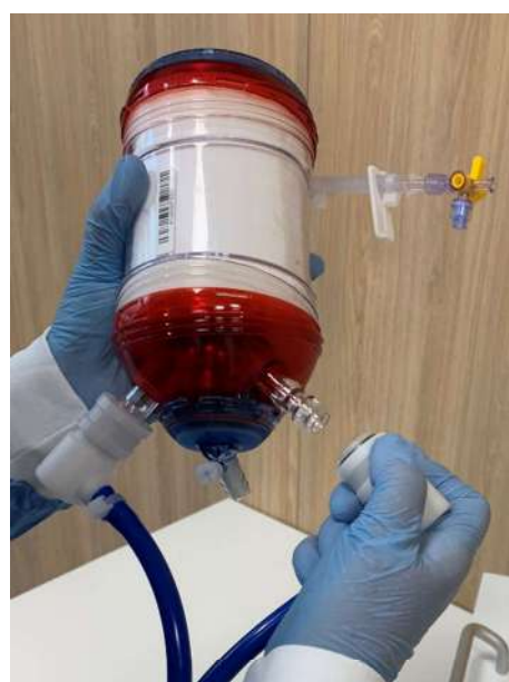
Рисунки 18а и 18b – Соединение быстроразъемных соединений Hansen с входным и выходным отверстиями теплообменника
