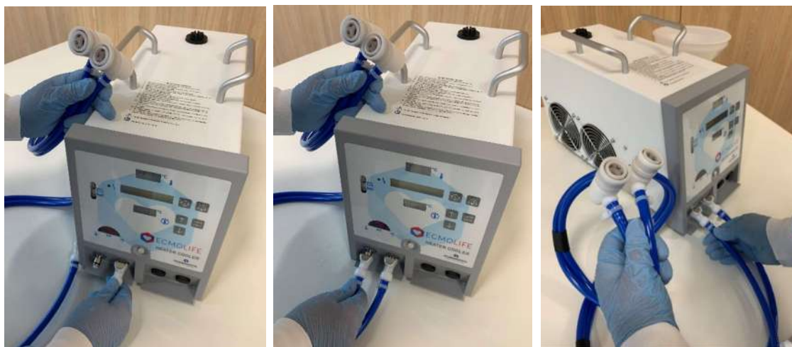
Рисунки 16а, 16б, 16с – Соединение муфты шланга на муфтах устройства
