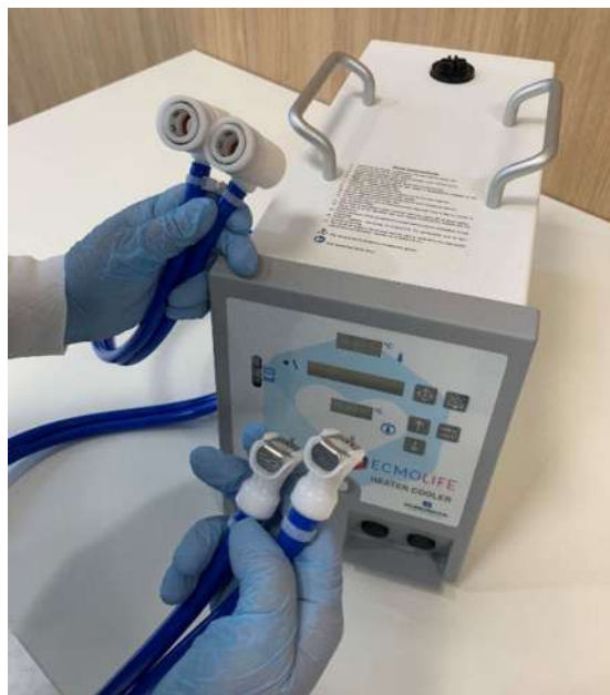
Рисунки 21а и 21b – Отсоединение шлангов от ECMOLIFE HC
