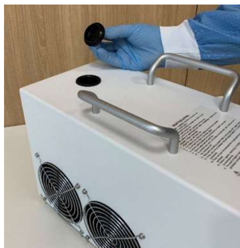
Рисунки 13а и 13б – Отвинчивание крышки
