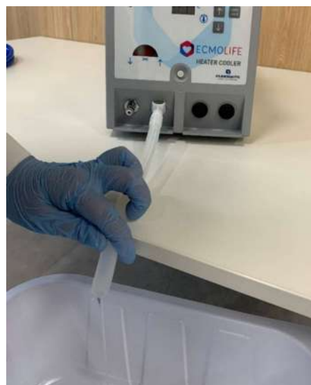
Рисунок 23 – Слив содержимого резервуара
