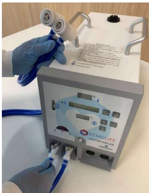
Рисунки 21а и 21b – Отсоединение шлангов от ECMOLIFE HC
