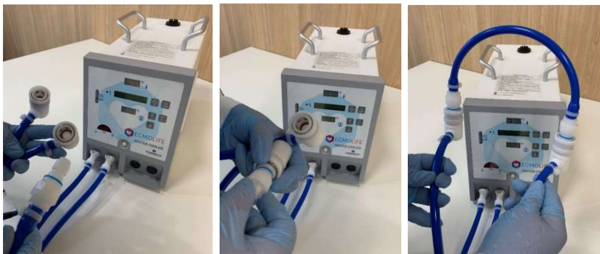
Рисунок 24 – Соединение соединительной трубки Hansen со шлангами
