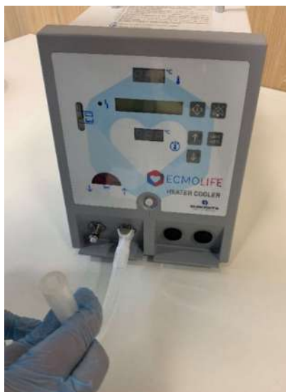
Рисунок 23 – Слив содержимого резервуара
