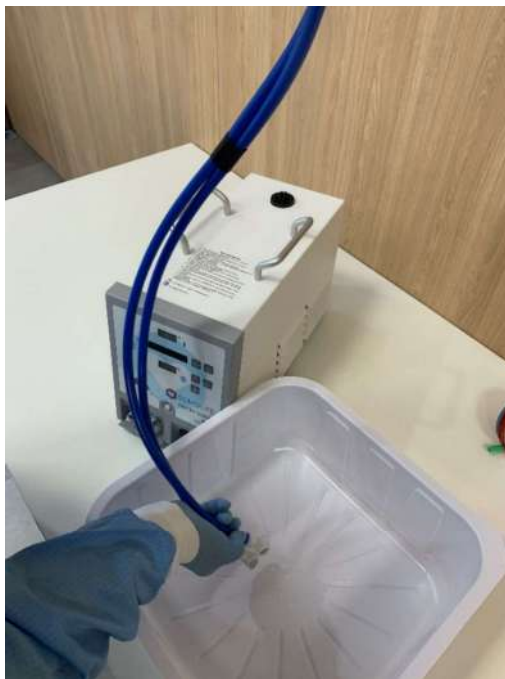
Рисунок 22 – Опорожнение шлангов для воды
