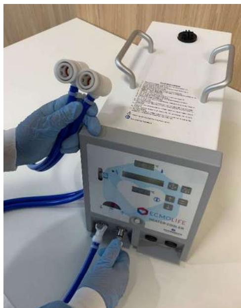
Рисунок 17 –Отсоединение муфт шлангов от муфт устройства
