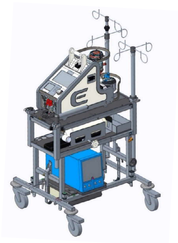
Рисунок 12 – Охладитель-нагреватель ECMOLIFE HC на специальной полке Leonardo
