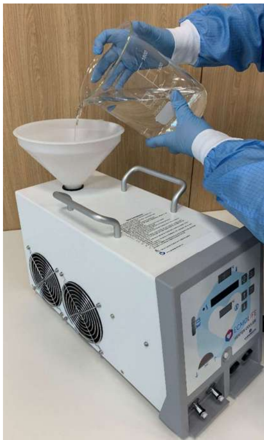
Рисунок 14 – Процедура заполнения системы водой
