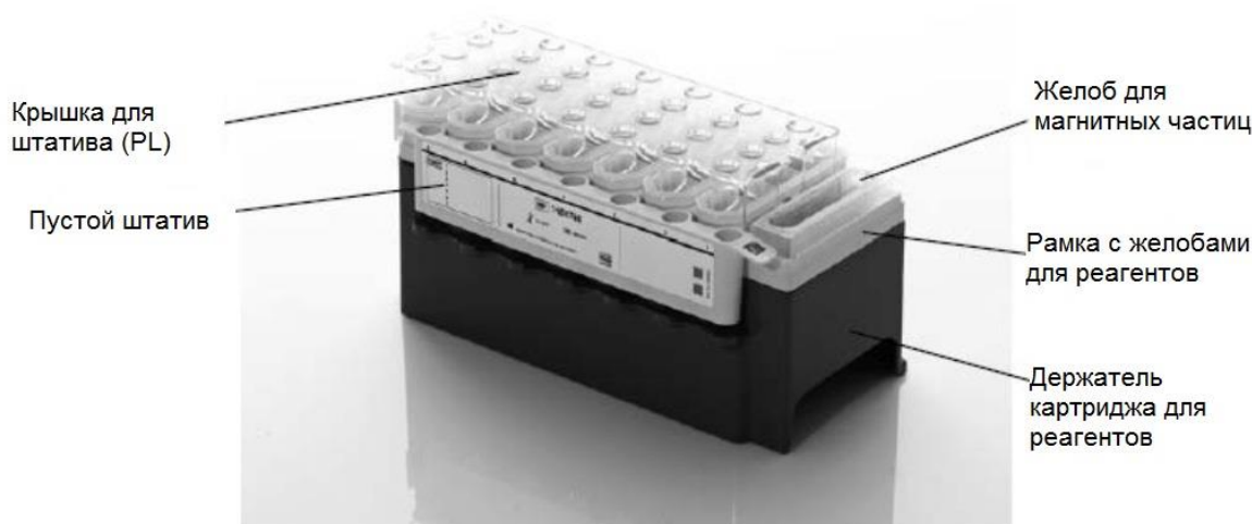
Рисунок 2. QIAasympphony картридж с реагентами (RC). Картридж с реагентами (RC) содержит все реагенты, необходимые для выполнения протокола.
