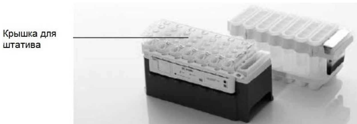
Рисунок 3. Простая настройка рабочего стола с использованием картриджей для реативов (RC).
