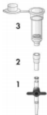
Рисунок 3. Сборка компонентов QIAamp DSP DNA Blood Mini Kit для вакуумной обработки образцов.
