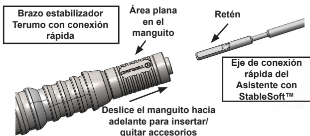
Figura 3 - Conexión del Asistente con StableSoft™ al brazo estabilizador Terumo con conexión rápida
