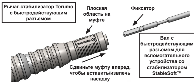
Рисунок 3. Крепление вспомогательного устройства со стабилизатором StableSoft™ к рычагу-стабилизатору Terumo с быстродействующим разъемом
