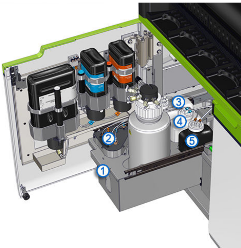
Рисунок 77: Зона хранения резервуаров для рабочих растворов (Alinity i)
