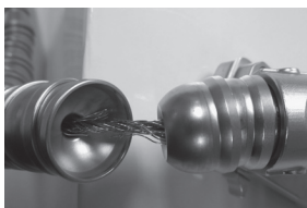
Figura 8 - Cavo con segni di logoramento e sfilacciamento
