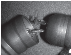
Rysunek 4 – Wygląd postrzępionej linki – NIE UŻYWAĆ
