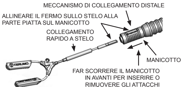
Figura 5 - Collegamento del dispositivo accessorio al braccio stabilizzatore universale Hercules™ 3 o al braccio stabilizzatore Herc Flex™ (codici prodotti T401161 e T401163)
