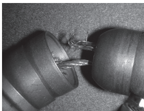
Рисунок 4 — Внешний вид расслоившегося тросика — НЕ ИСПОЛЬЗОВАТЬ
