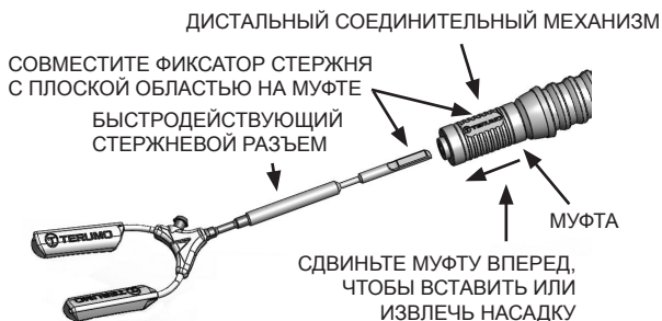
Рисунок 5 — Присоединение вспомогательного устройства к универсальному рычагу-стабилизатору Hercules™ 3 или к рычагу-стабилизатору Herc Flex™ (идентификационные номера изделий: T401161 и T401163)
