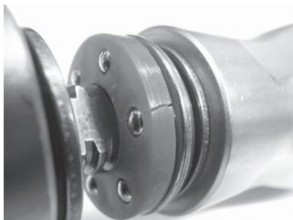
Рисунок 9 — Сломанная нейлоновая шайба
