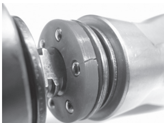
Rysunek 9 – Uszkodzona nylonowa podkładka
