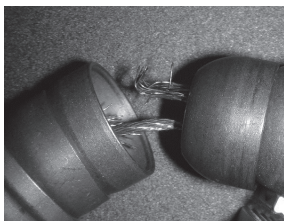
Figure 4 – Aspect d'un câble effiloché – NE PAS UTILISER
