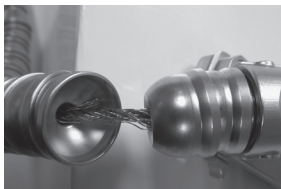
Figur 8 – Kabel med materialtretthet og slitasje
