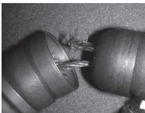
Figur 4 – Utseendet på en nött kabel – FÅR EJ ANVÄNDAS
