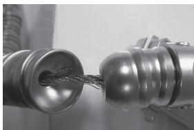
Rysunek 8 – Zużyta i postrzępiona linka
