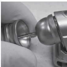
Kuva 3 – Normaalin kaapelin ulkoasu
