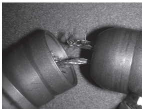
Şekil 4 – Yıpranmış bir kablounun görünümü – KULLANMAYIN
