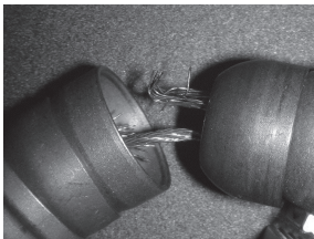
Afbeelding 4: voorbeeld van een rafelende kabel - NIET GEBRUIKEN
