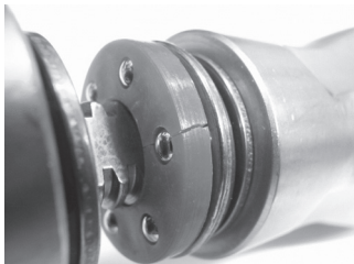
Obr. 9 – Prasklá nylonová podložka
