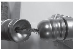
Kuva 8 – Kaapeli, jossa näkyy väsyminen ja rispaantuminen
