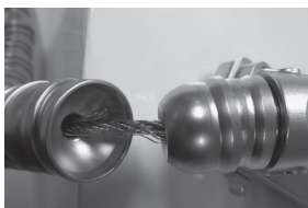
Figura 8 – Cable que muestra fatiga y desgaste
