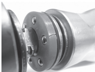
Figura 9 - Arruela de nylon quebrada
