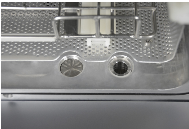
Рисунок 16. Не перекрывайте УФ-лампы.
