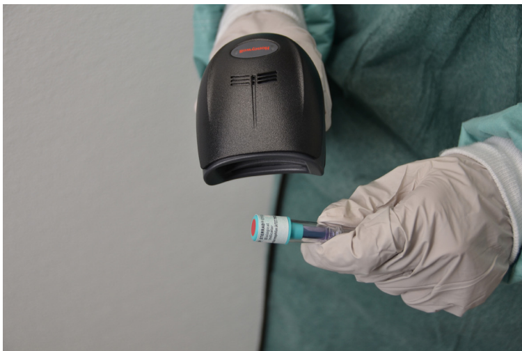
Рисунок 21. Сканирование биологического индикатора STERRAD VELOCITY.
