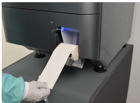
Рисунок 62. Вытяните бумагу через верхнюю часть дверцы и выровняйте ее по направляющим.
