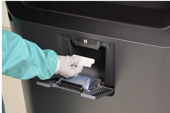
Рисунок 37. Извлеките пустой рулон бумаги.
