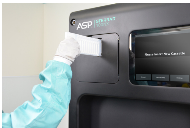
Рисунок 5. Установка кассеты в слот.
