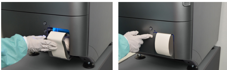
Рисунок 63. Придерживайте бумагу при закрывании дверцы принтера. Нажмите кнопку «Подача бумаги».
