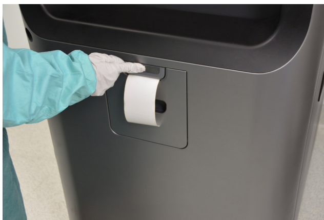
Рисунок 40. Нажмите кнопку «Подача бумаги».
