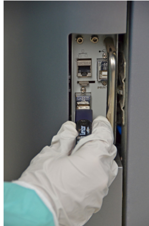
Рисунок 42. Вставьте запоминающее устройство в USB-порт.
