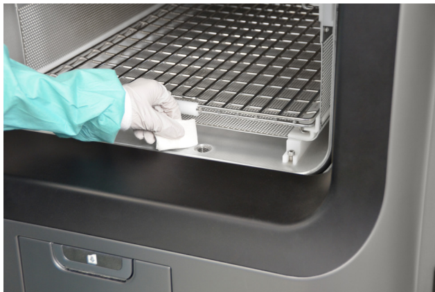
Рисунок 41. Чистка линзы монитора пероксида водорода.
