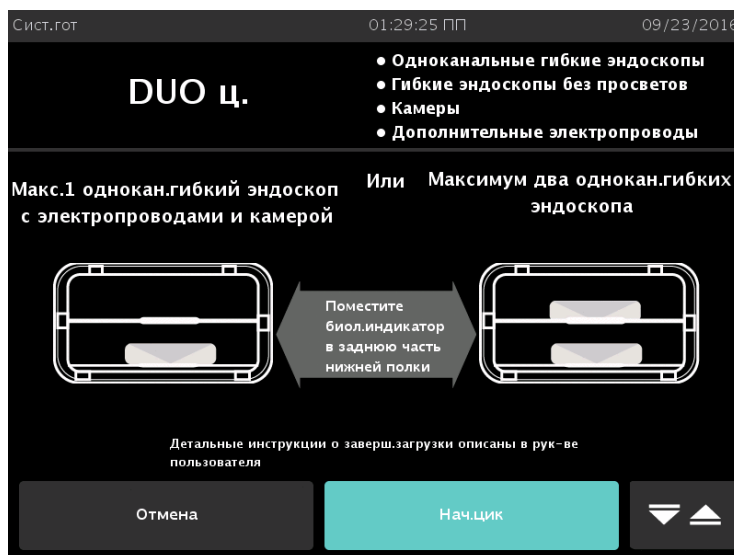
Рисунок 16с. Загрузите камеру для цикла DUO.
