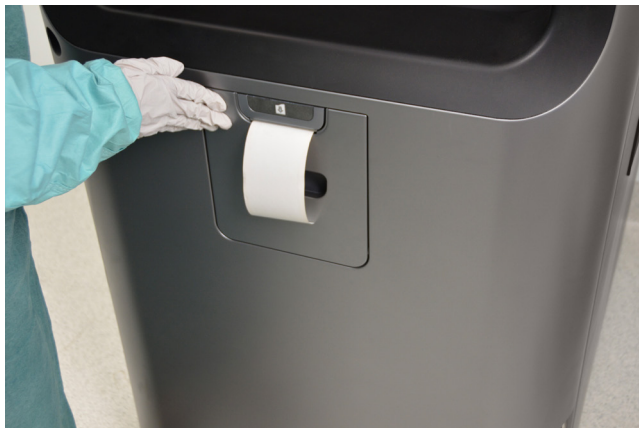
Рисунок 39. Убедитесь, что дверца принтера плотно закрыта, а бумага правильно расположена.
