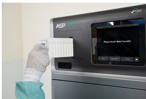
Рисунок 12. Установка кассеты в слот.
