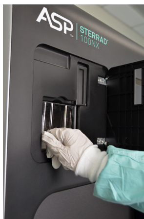
Рисунок 33. Откройте панель доступа и извлеките использованную коробку для кассеты.
