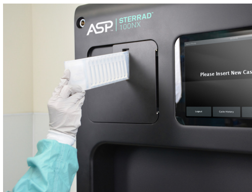
Рисунок 27. Не вставляйте кассету под углом.
