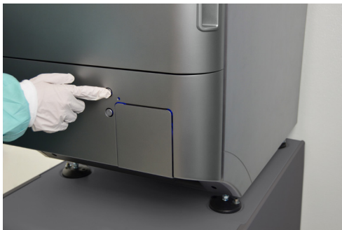
Рисунок 59. Откройте дверцу принтера.
