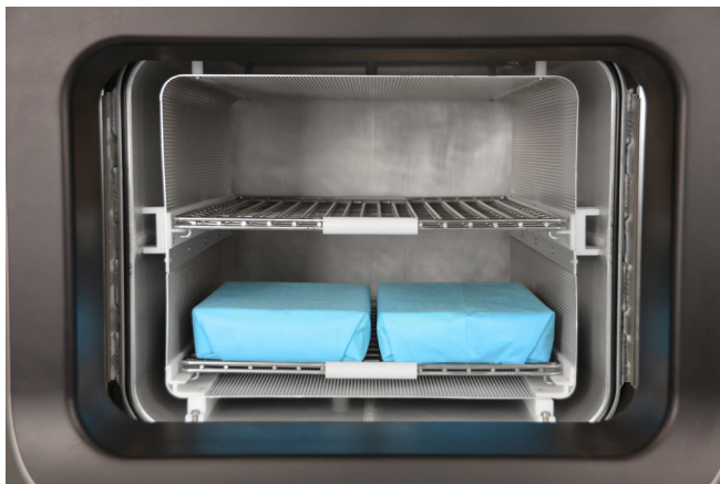
Рисунок 12. Правильно размещенные стерилизуемые объекты для обработки в цикле EXPRESS.
