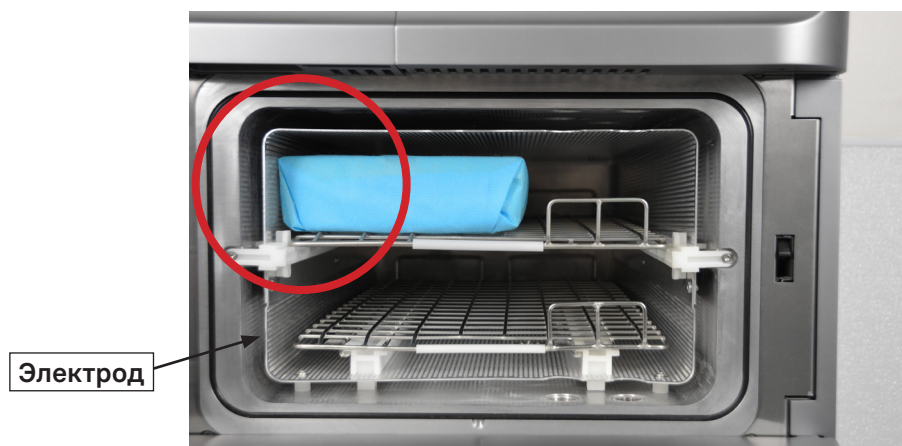
Рисунок 14. Стерилизуемые объекты НЕ должны касаться электрода.
