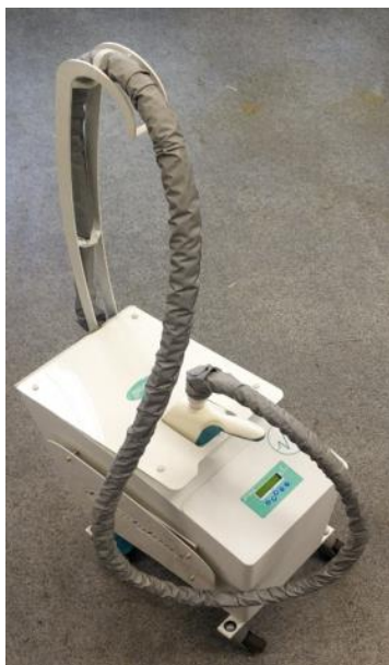
а) Вариант исполнения I: устройство с вакуумно-роликовой манипулой и основным блоком в металлическом корпусе
