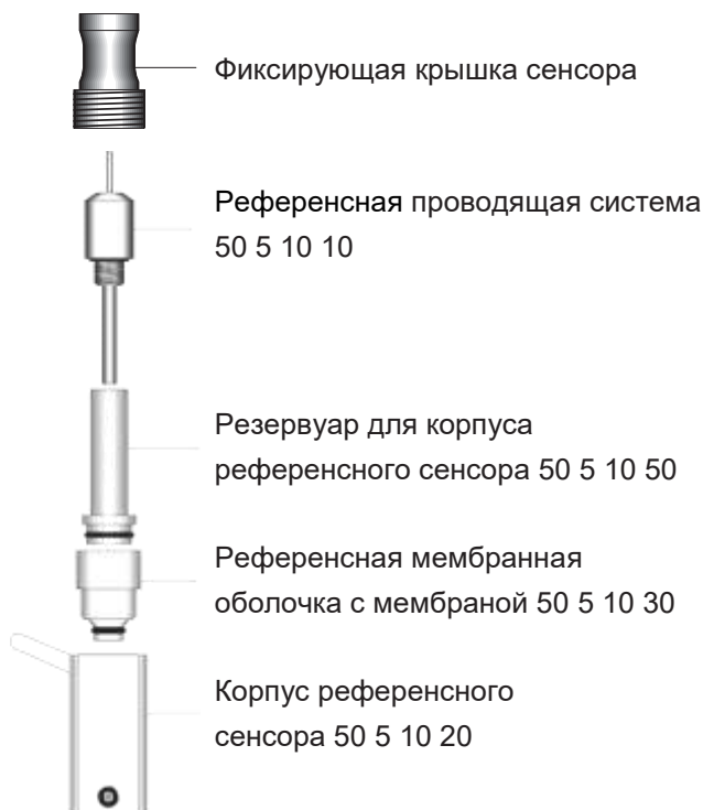
Рисунок 38 Референсный сенсор в разобранном виде (50 5 10 00)
