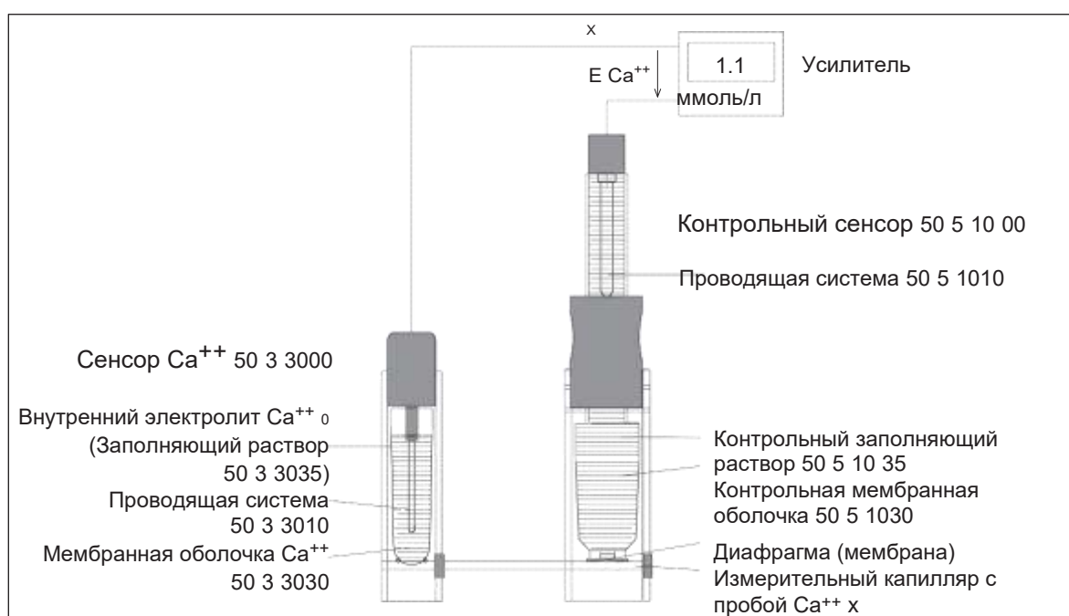
Рисунок 35 Устройство измерительной цепи сенсора \text{Ca}^{++}
