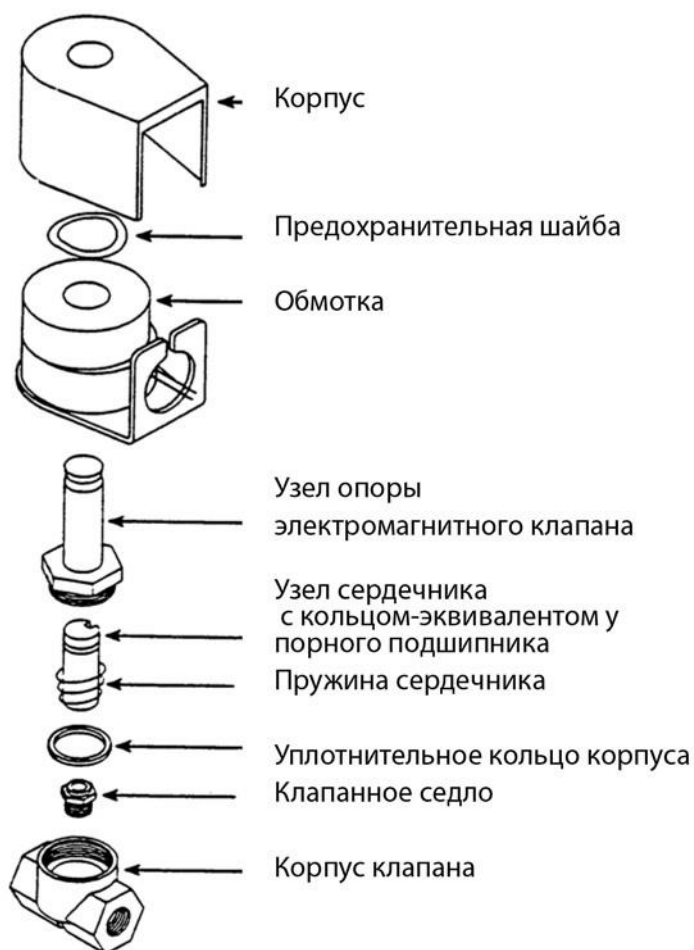
Рисунок 4-1. Вид клапана в разобранном виде
