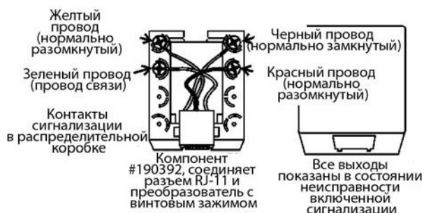
Рисунок 1-5. Контакты сигнализации в распределительной коробке
