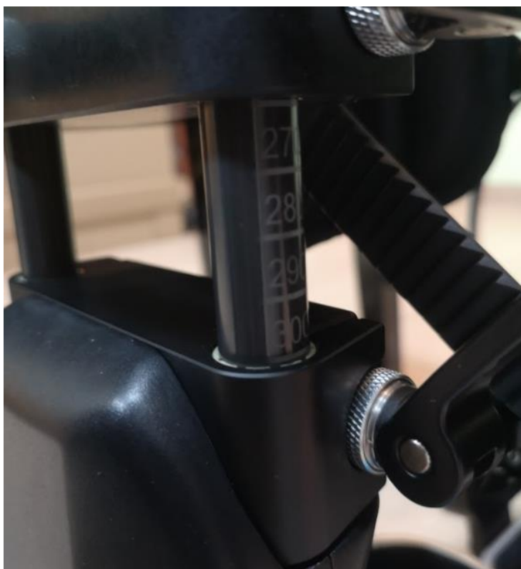
Рисунок 29 — Гравировка длины голени (размер 300).
