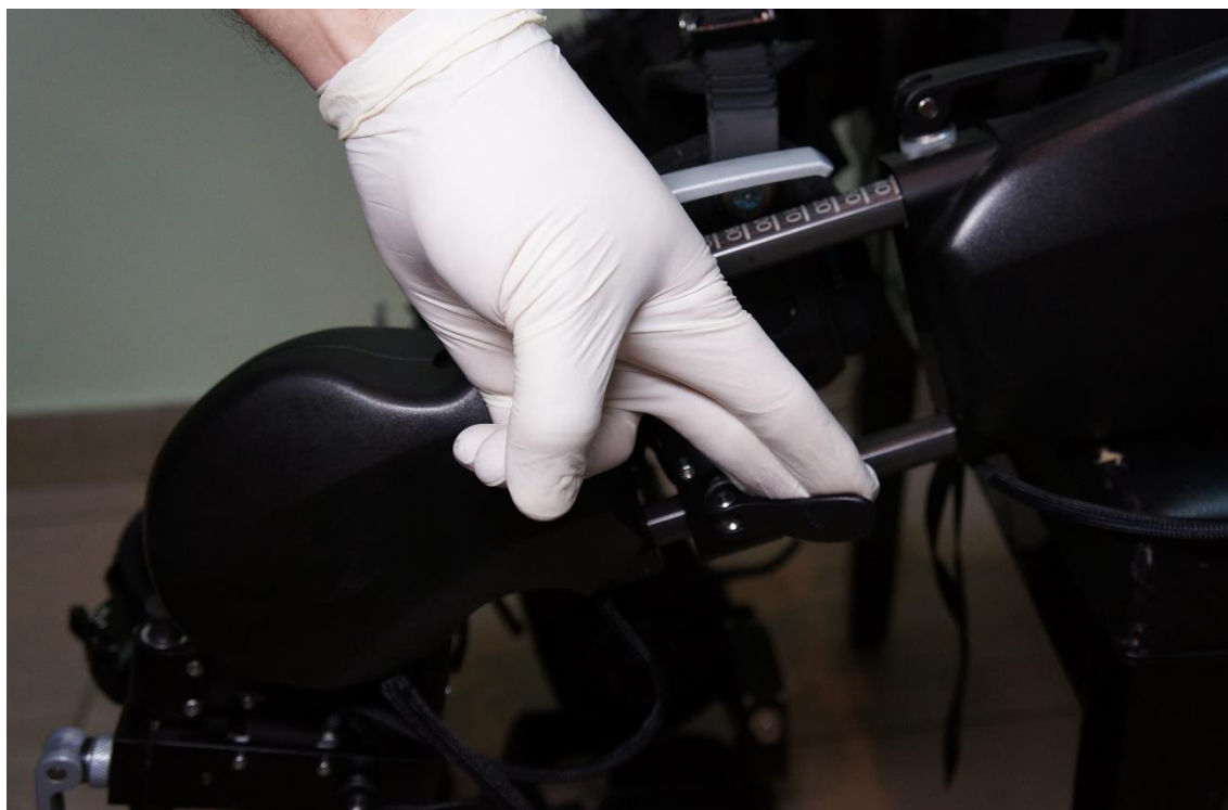
Рисунок 42 — Зажимная рукоятка механизма фиксации крепления бедренного.
