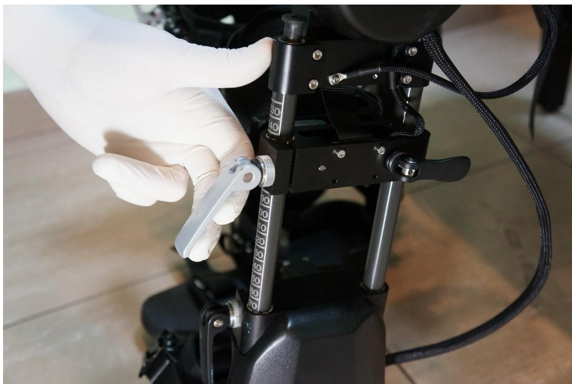
Рисунок 39 — Зажимная рукоятка механизма фиксации положения крепления голени.
