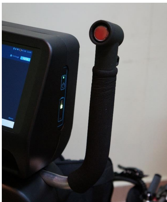
Рисунок 59 — Правая рукоятка Экзоскелета с кнопкой аварийной остановки.
