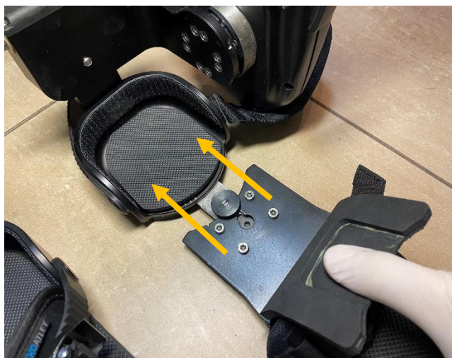
Рисунок 16— Установка крепления стопы.
