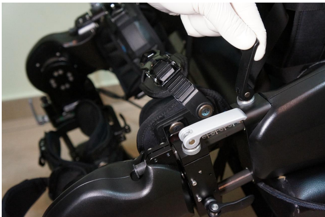
Рисунок 30 — Зажимная рукоятка механизма регулировки длины бедра.
