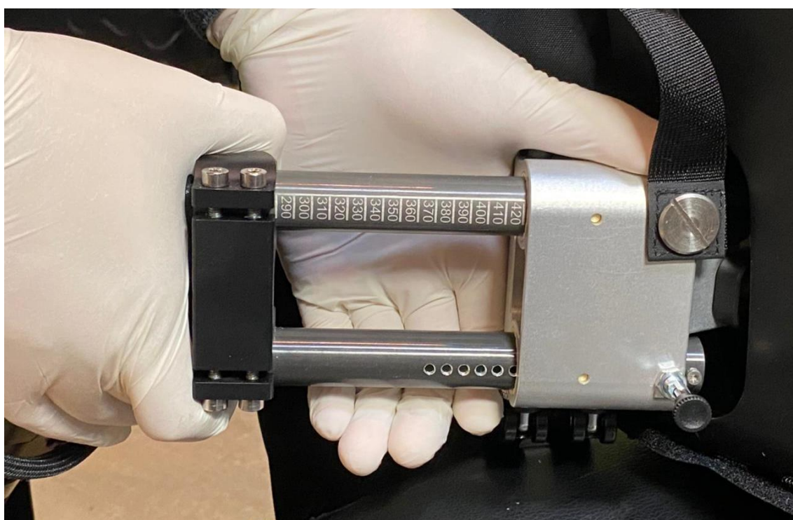
Рисунок 36 — Настройка ширины таза.
