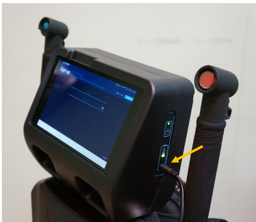
Рисунок 6 — Подключение зарядного устройства Экзоскелета.
