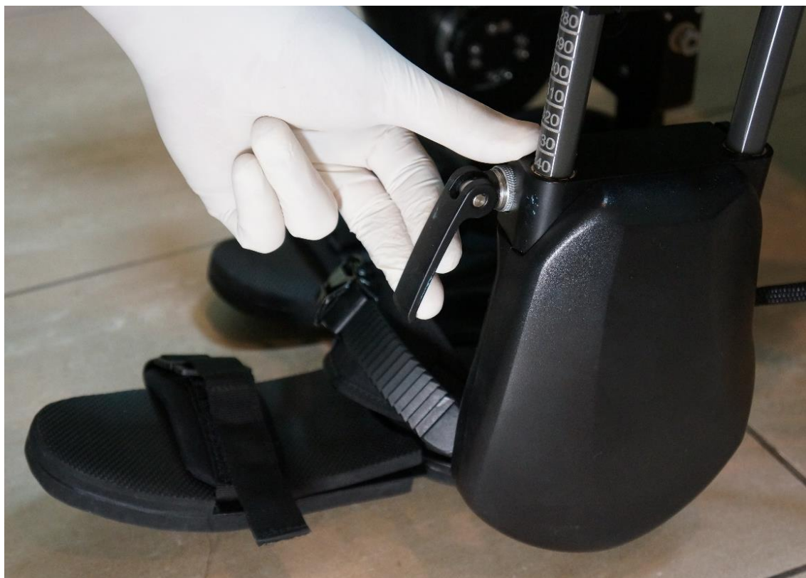
Рисунок 27 — Зажимная рукоятка механизма регулировки длины голени Экзоскелета.
