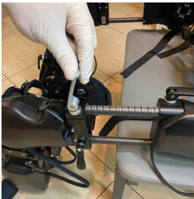
Рисунок 45 — Настройка положения крепления бедренного.
