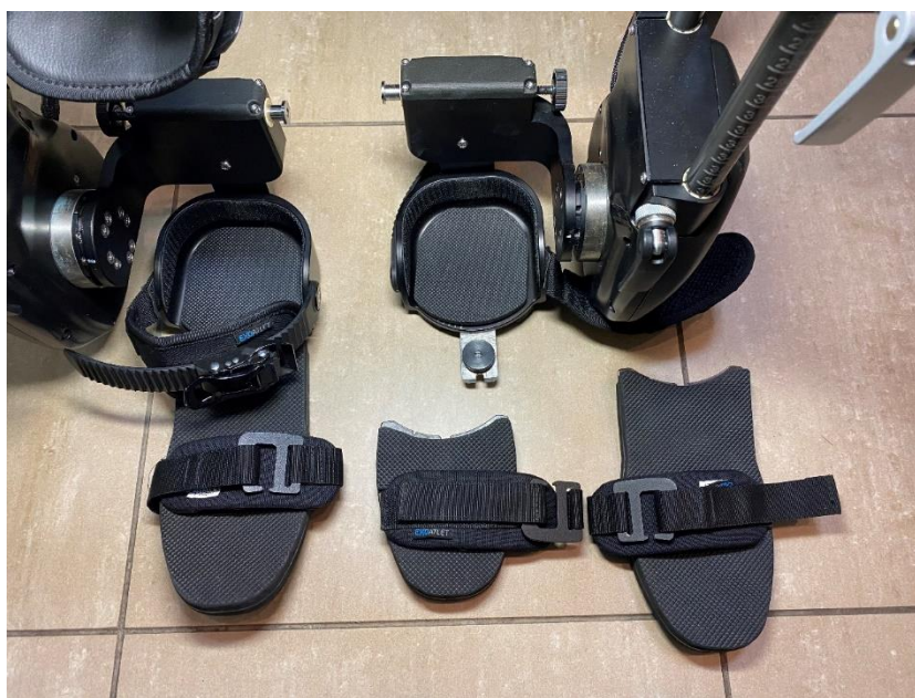
Рисунок 10 — Типоразмеры креплений стопы Экзоскелета.
