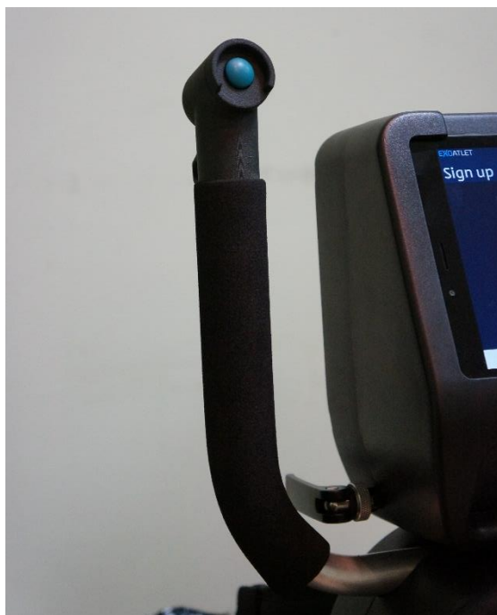
Рисунок 58 — Левая рукоятка Экзоскелета с функциональной кнопкой.
