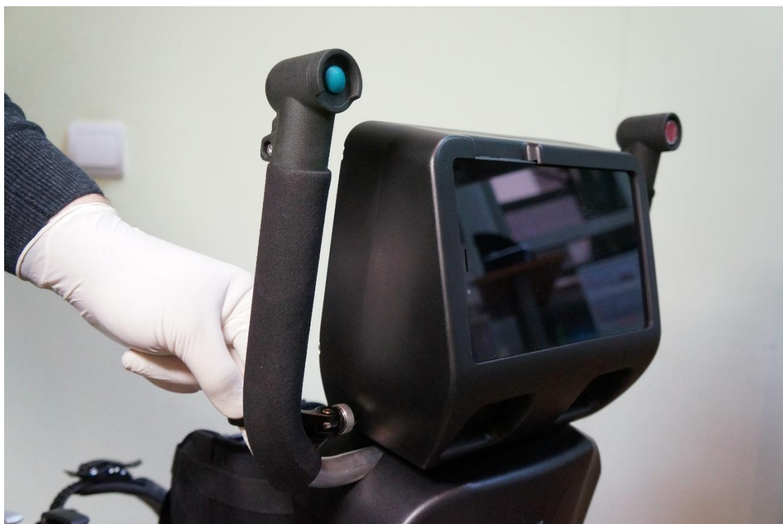
Рисунок 46 — Зажимная рукоятка механизма фиксации положения спинки Экзоскелета.
