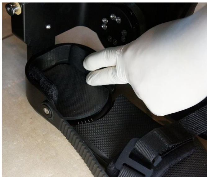
Рисунок 26 — Установка боковых вкладышей крепления стопы.
