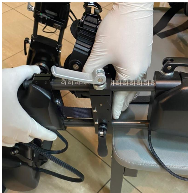
Рисунок 45 — Настройка положения крепления бедренного.
