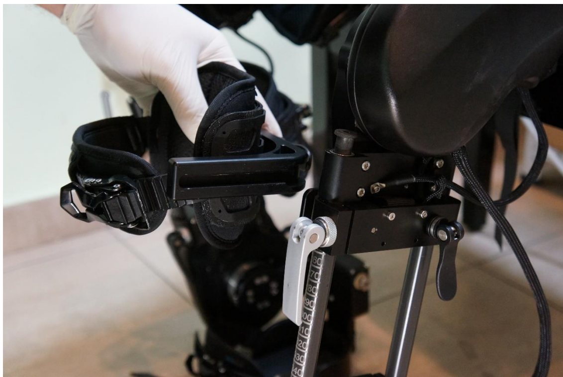
Рисунок 38 — Установка крепления голени.
