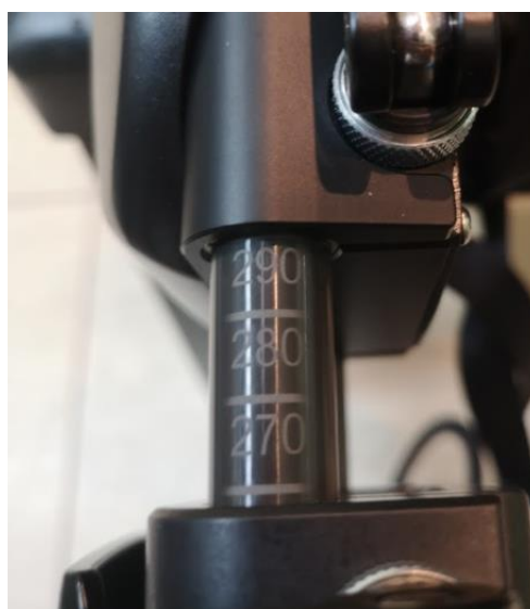
Рисунок 32 — Гравировка длины бедра (размер 290 мм).
