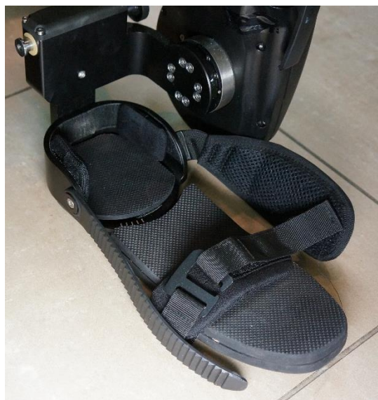
Рисунок 26 — Установка боковых вкладышей крепления стопы.
