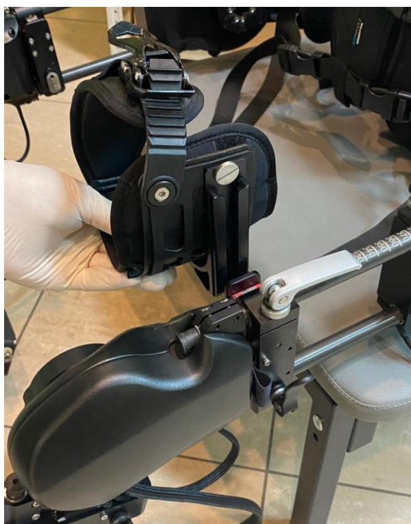
Рисунок 43 — Установка крепления бедренного.
