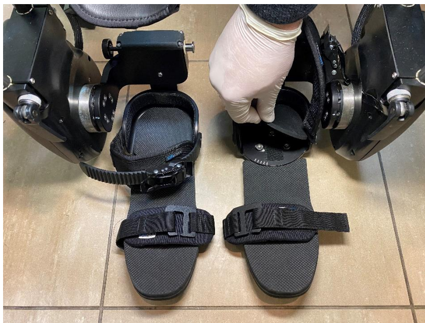
Рисунок 24 — Настройка инверсии/эверсии крепления стопы.
