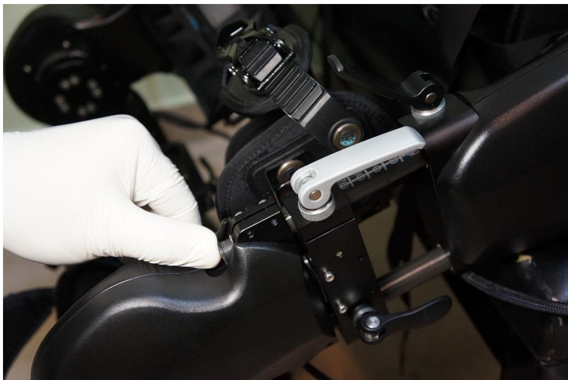
Рисунок 31 — Кнопка-фиксатор механизма регулировки длины бедра.
