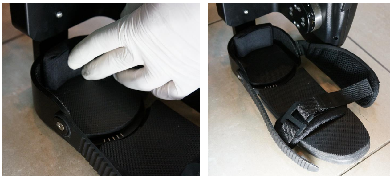
Рисунок 25 — Установка вкладыша крепления стопы.
