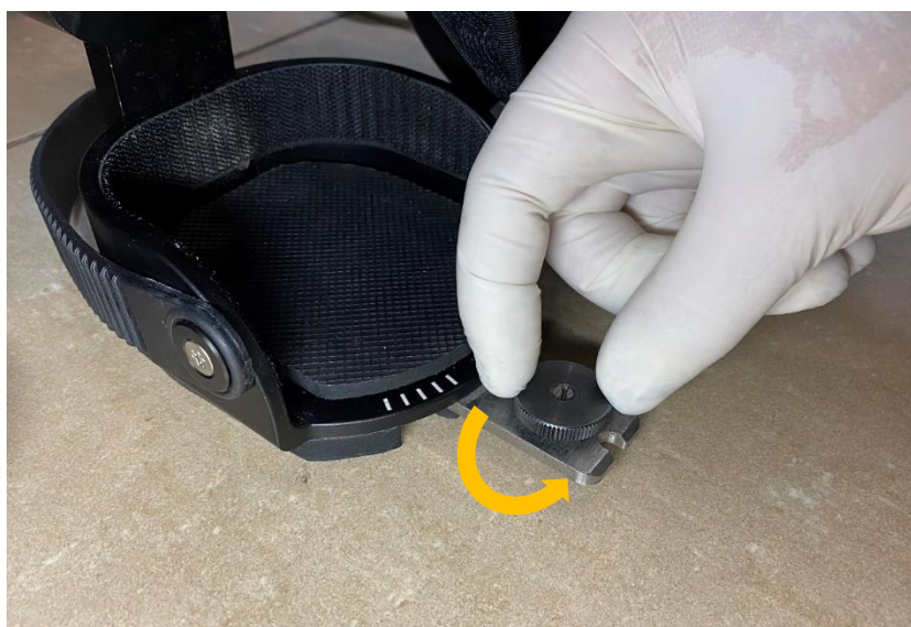
Рисунок 15 — Ослабление винта крепления.
