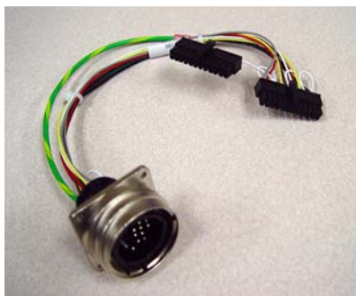
Рисунок 16 - 3. Дополнительный жгут 3016360/60163802 (слева); соединения дополнительного жгута ISI с разъемами P404 и P403 (справа)
