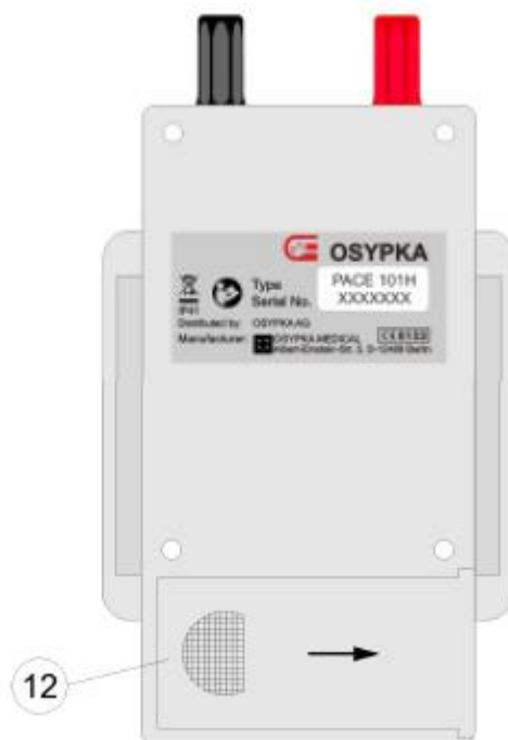
Рисунок 4: Доступ к отсеку для батареи
