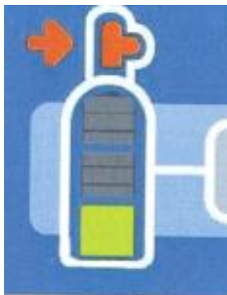
Рисунок 7: Индикатор низкого давления
