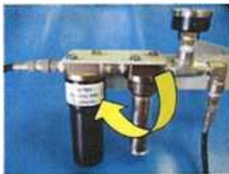
Рисунок 24: снятие патрона осушительного фильтра
