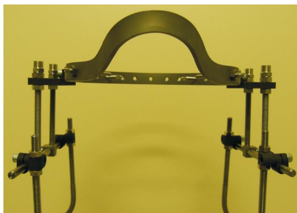
Рис. 8. Техническое решение соединения узла фиксации головы.
