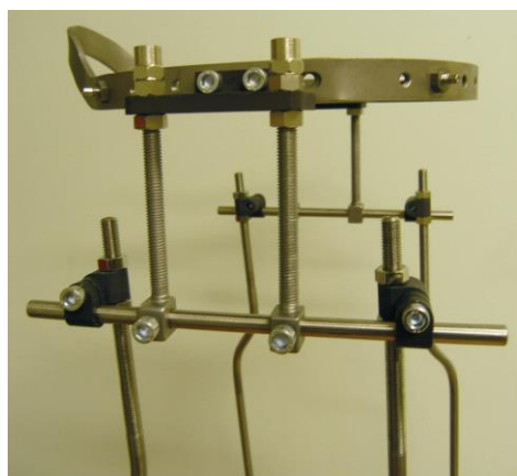
Рис. 8. Техническое решение соединения узла фиксации головы.
