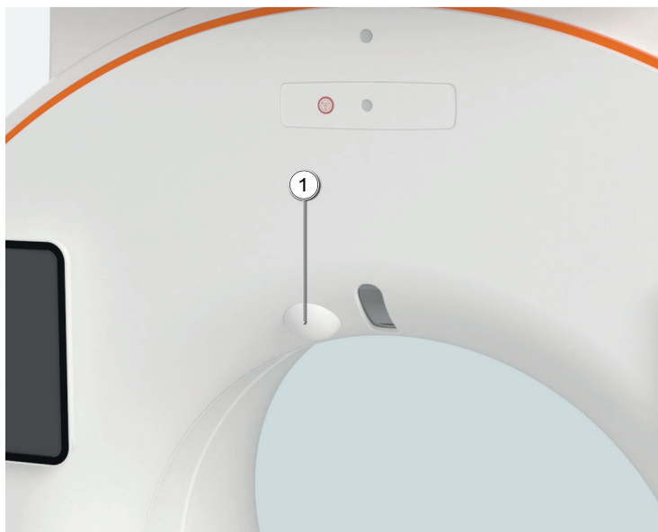
(1) Камера наблюдения за пациентом на передней стороне гентри
