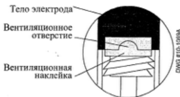
Рисунок 6. Вентиляционная наклейка на мембране.
