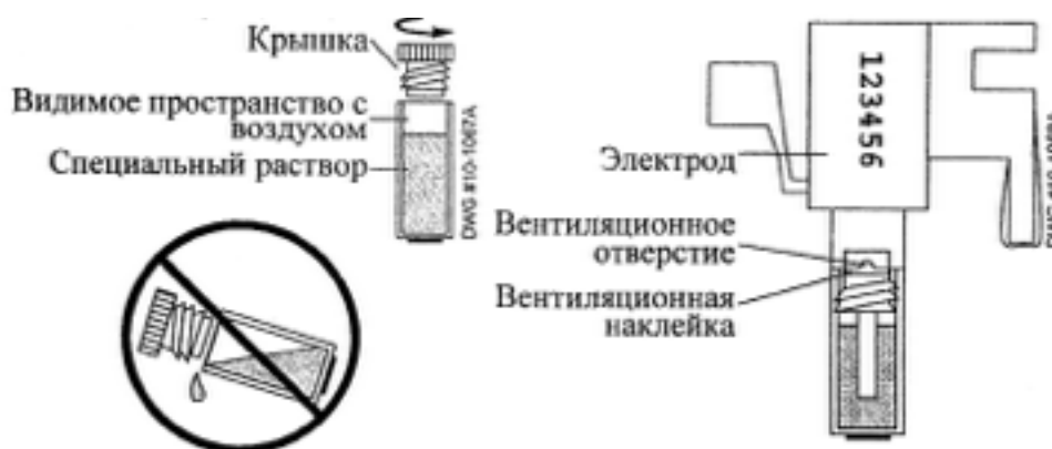
Рисунок 5. Мембрана PCO 2 (отвинтить крышку и установить на электрод)
