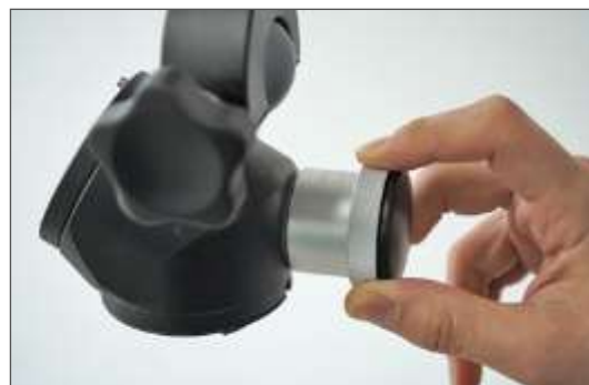
2. Снимите пылезащитную крышку с оптического разъема.
