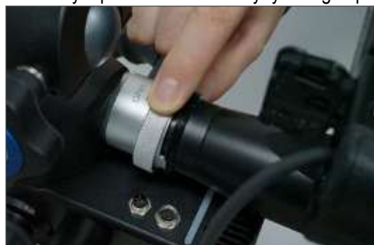
5. Установите 4K-адаптер в оптический разъем и зафиксировать с помощью кольца.
