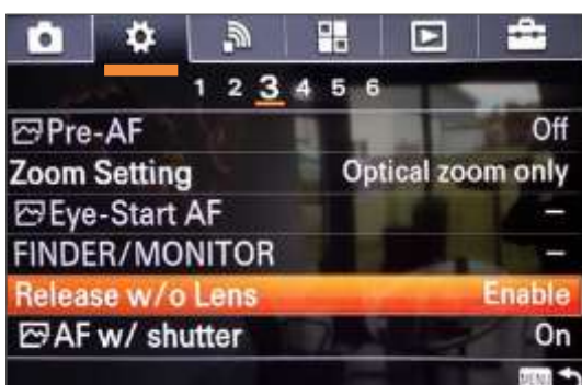
5. Выберите [Enable] в пользовательских настройках камеры Sony, чтобы активировать функцию затвора, поскольку не подключен общий объектив
