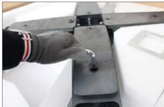
2. Снимите балансировочные грузы, ослабив винты шестигранным ключом 8 мм. Винты закреплены внизу гайками M12 (размер ключа 19 мм).
