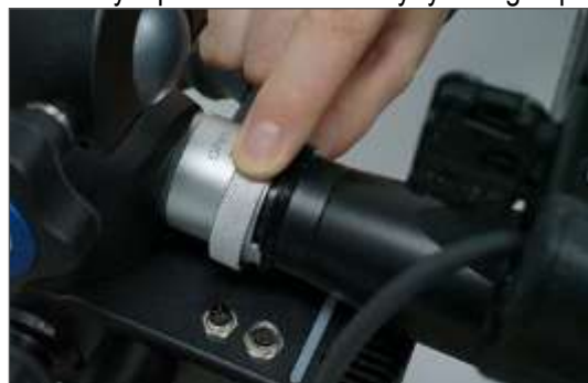
5. Установите 4K-адаптер в оптический разъем и зафиксируйте с помощью кольца.
