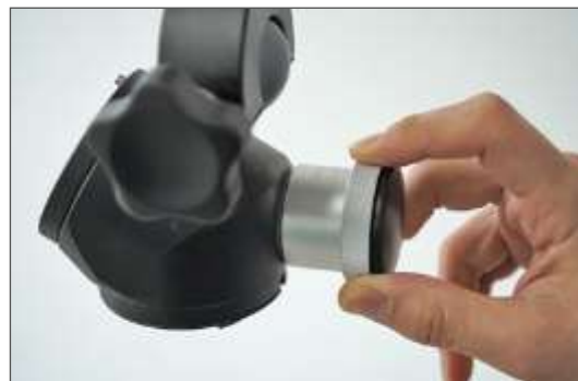
2. Снимите пылезащитную крышку с оптического разъема.
