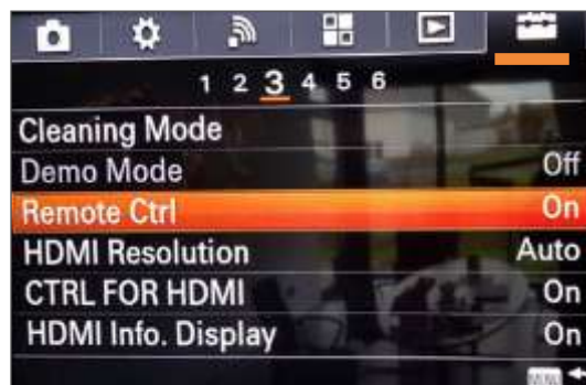
6. Для модели Flexion оборудованной сенсорной кнопкой. Чтобы обеспечить работу сенсорного блока должен быть установлен режим "Remote Ctrl" в меню настройки камеры Sony.
