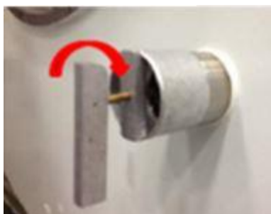
Рисунок 2-37: Устройство вакуумного торможения накрученное на заглушку вакуумного порта
