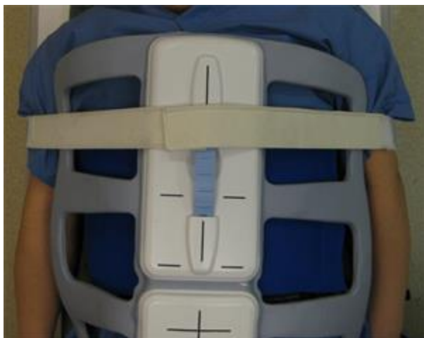
Рисунок 6-93: Катушка, размещенная поверх пассивного генератора и сильфонных датчиков
