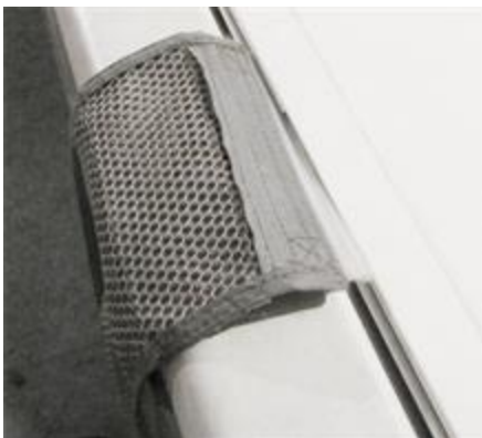
Рисунок 2-44: Ремешок, продетый в направляющие на столе
