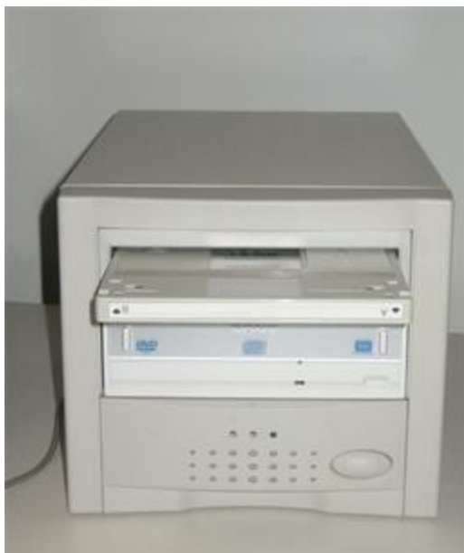
Рисунок 8-17: Магнитооптический диск, вставленный в устройство
