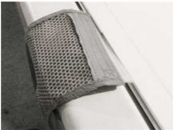
Рисунок 4-2: Ремешок, продетый в направляющие на столе
