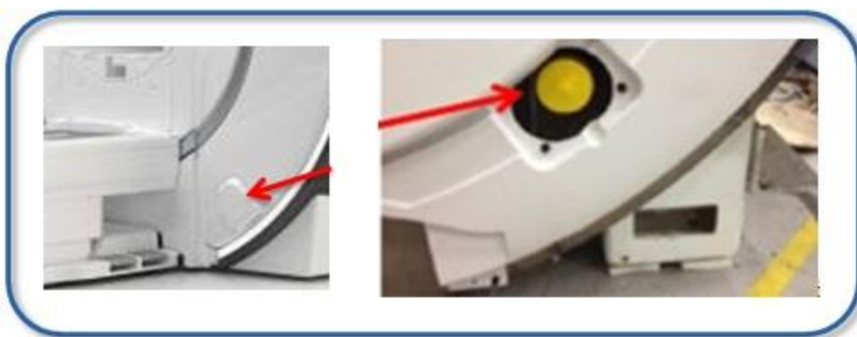
Рисунок 2-35: Пример вакуумного порта без крышки
