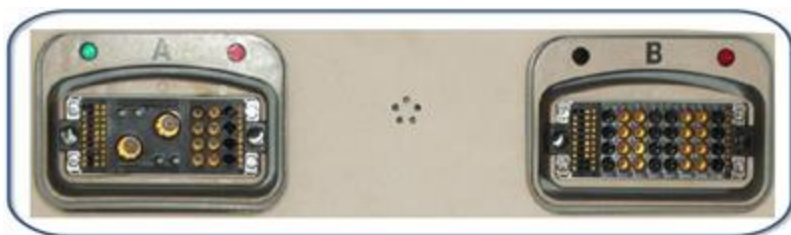
Рисунок 3-31: Катушечный блок: 1 — идентичные разъемы для 8- или 16-канальных катушек, А — разъем для старых катушек
