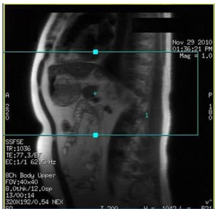
Рисунок 6-71: Пример графического задания единичного блока при сканировании LAVA-Flex
