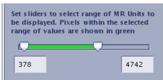
Рисунок 7-170: Пороговый ползунок, левый ползунок = нижний порог, правый ползунок = верхний порог
