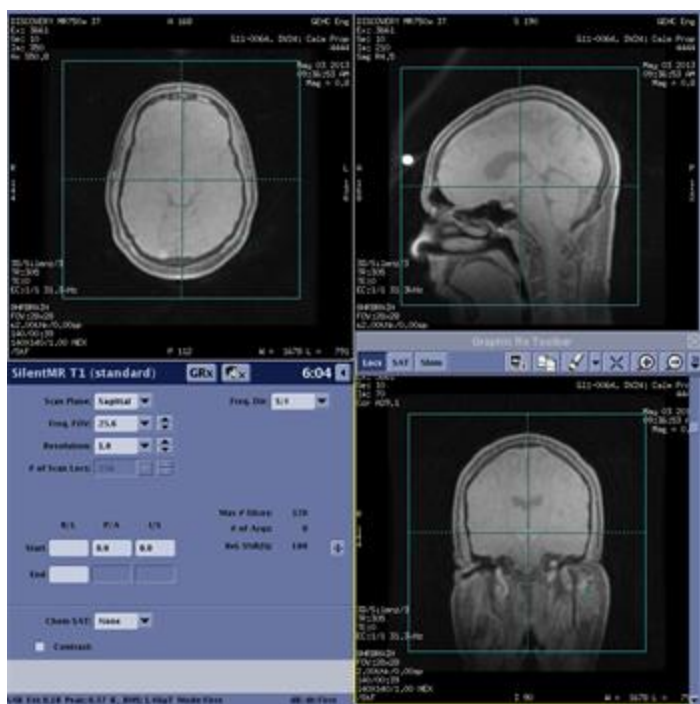
Рисунок 6-119: Определение блока Silenz в Graphic Rx с воздушным зазором вокруг головы
