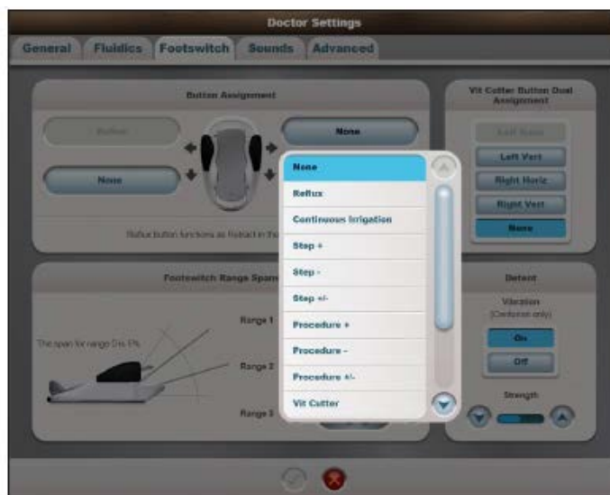
Рисунок 2-10 Диалоговый экран установок доктора - Клавиша выбора задания Нажатие на одну из клавиш выбора задания приводит к появлению всплывающего меню функций, которые могут активизироваться при нажатии носком ноги хирурга. Отдельные выделения скрыты ниже выделений, показанных здесь; полоса прокрутки справа используется для экспозиции остальных выделений.
