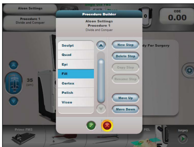
Рисунок 2-54 Диалог построения процедуры с добавленным шагом «Заполнение (Fill)» В данном случае шаг «Заполнение (Fill)» был выбран из правой колонки диалога шагов (смотрите предыдущий рисунок). Шаг «Заполнение (Fill)» появляется внизу существующих шагов, затем была нажата клавиша «Перемещение вверх (Move Up)», чтобы переместить шаг «Заполнение (Fill)» после шага «Надъядерный слой (Epi)». Большое количество шагов может добавляться, удаляться или перемещаться до сохранения действия с помощью нажатия зеленой кнопки (P).
