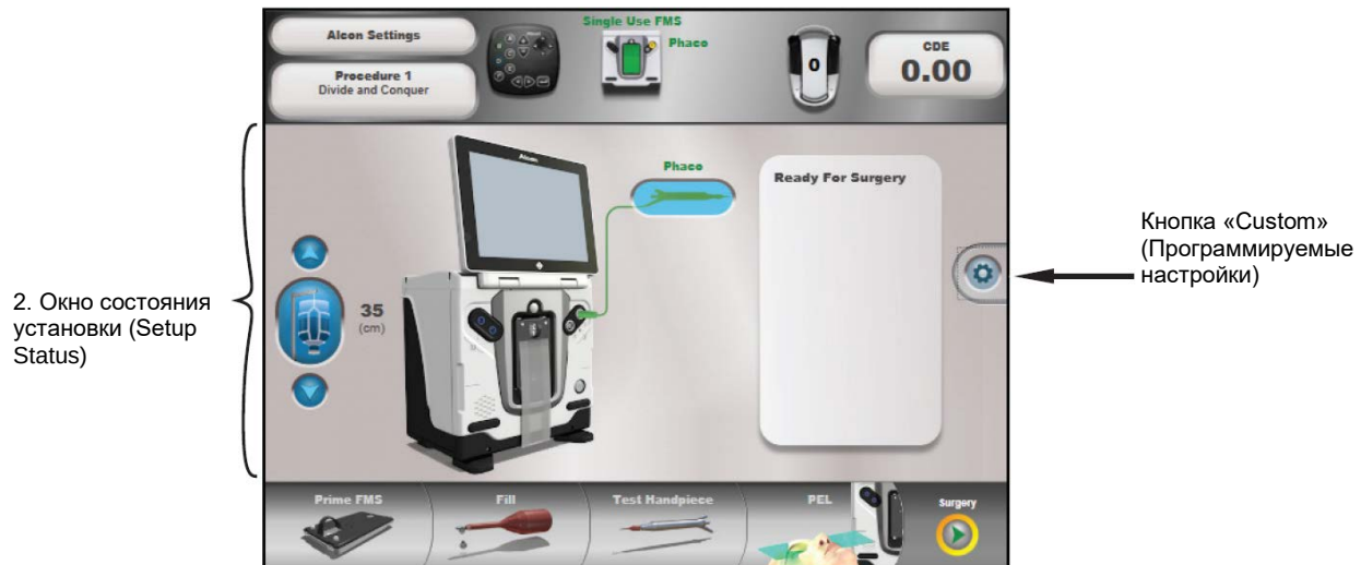
Рисунок 2-38 Окно состояния установки
