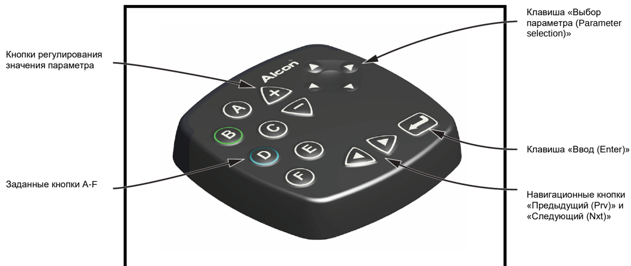
Рисунок 2-20 Пульт дистанционного управления
