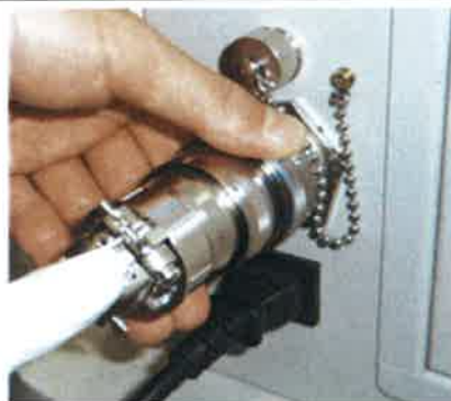
② Присоедините кабель соединения коммутационного блока со столом
