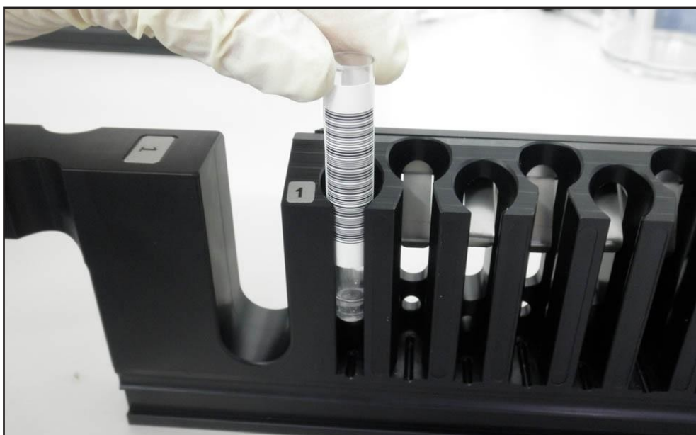
Рис. 8: Размещение пробирок в штативе для пробирок (за исключением серии 33 и серии без встроенного пробоотборника)
