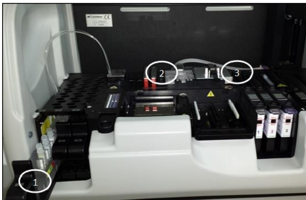
Рис. 10: Размещение вспомогательного оборудования Easy Fix (только для Interlab G26 Easy Fix)
