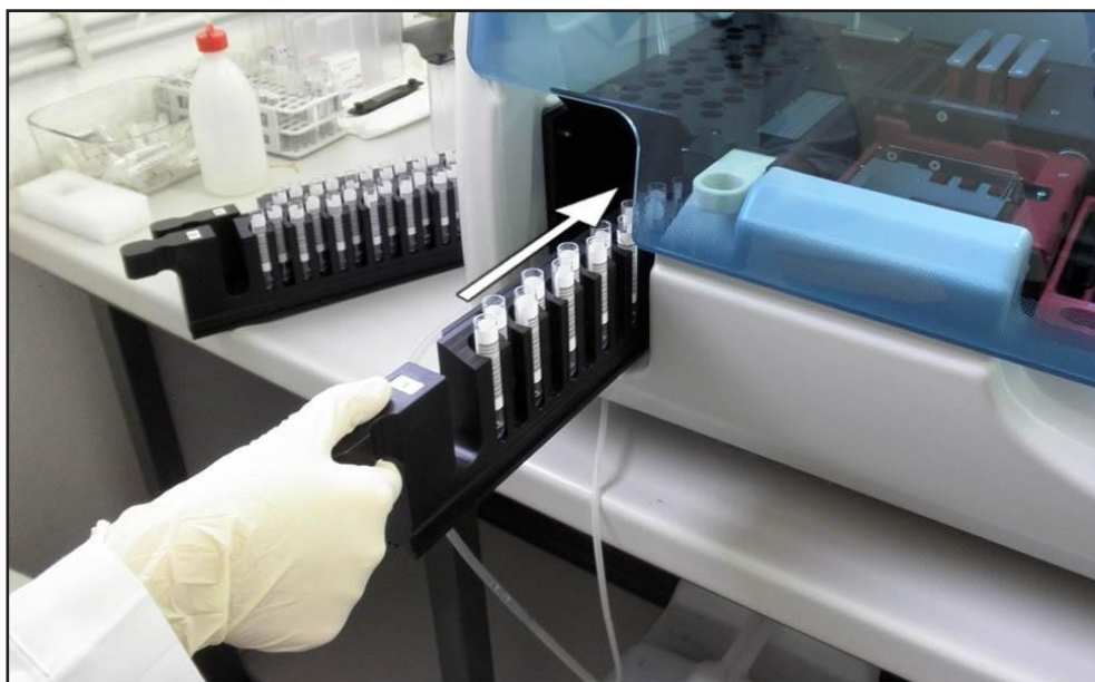
Рис. 9: Размещение штатива держателя для пробирок (только для приборов со встроенным пробоотборником)
