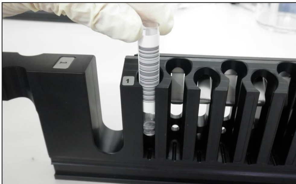
Рис. 8: Размещение пробирок в штативе для пробирок (только для серии со встроенным пробоотборником)
