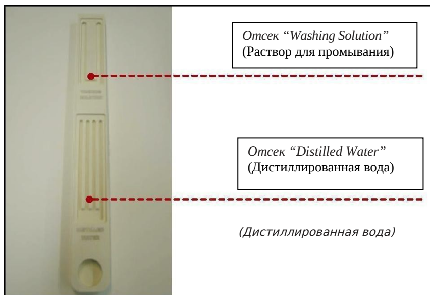
Рис.2: Планка для промывания аппликаторов (только серия 33)
