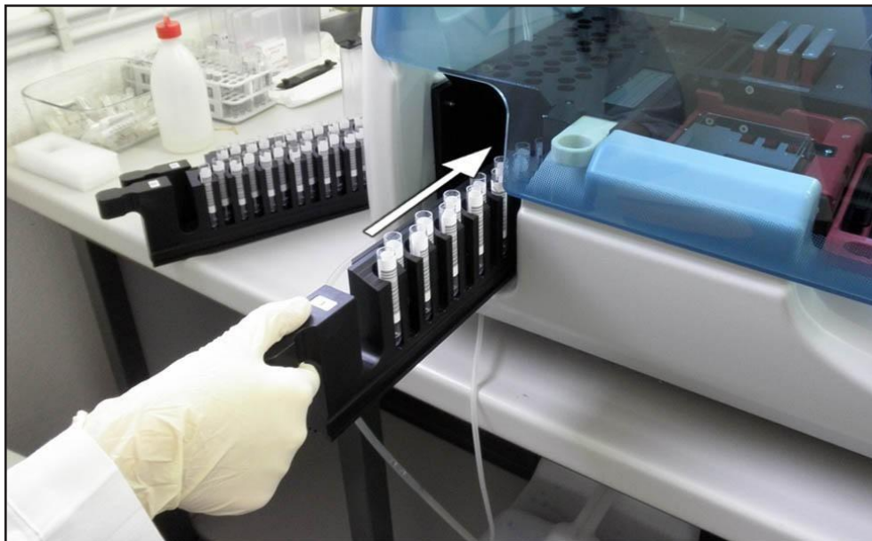
Рис. 9: Размещение штатива держателя для пробирок (только для серии со встроенным пробоотборником)
