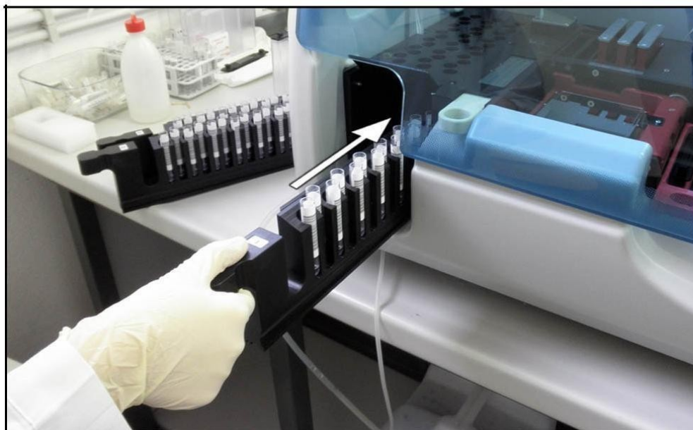
Рис. 9: Размещение штатива держателя для пробирок (только для приборов со встроенным пробоотборником)
