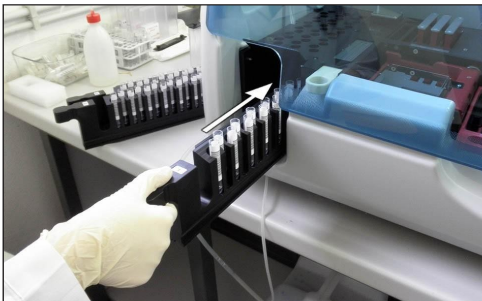
Рис.9: Размещение штатива держателя для пробирок
