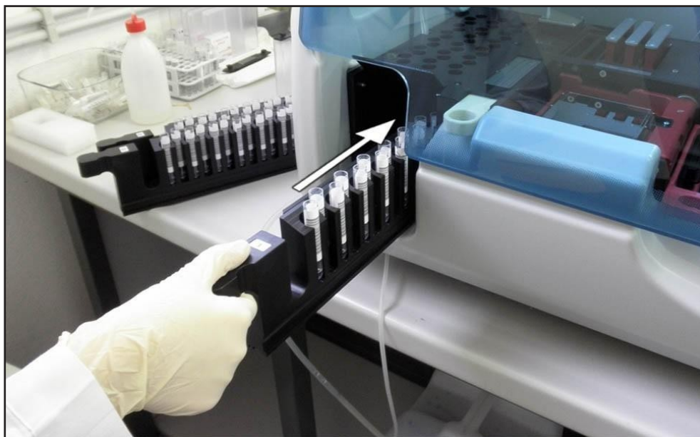
Рис. 9: Размещение штатива держателя для пробирок (за исключением серии 33 и серии без встроенного пробоотборника)
