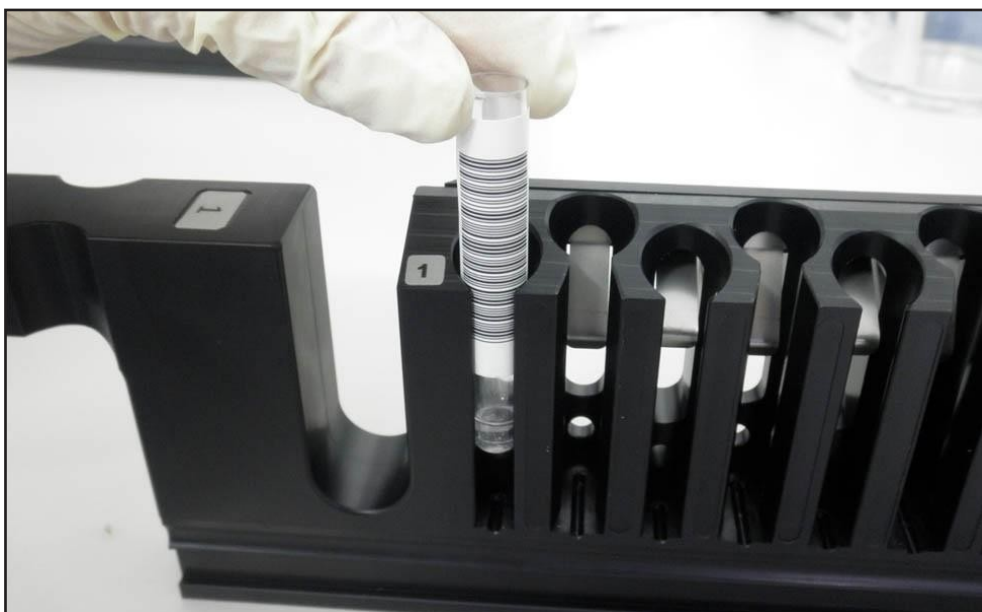
Рис. 8: Размещение пробирок в штативе для пробирок (только для приборов со встроенным пробоотборником)
