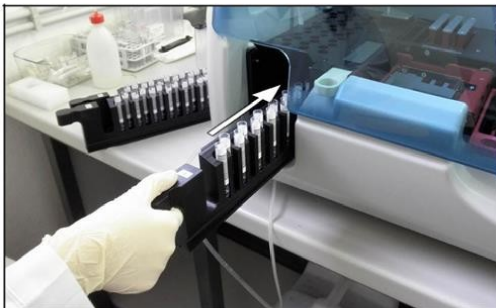
Рис.9: Размещение штатива держателя для пробирок
