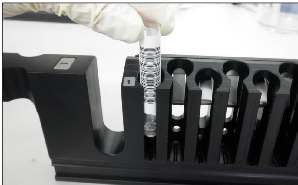
Рис. 8: Размещение пробирок в штативе для пробирок (только для серии со встроенным пробоотборником)
