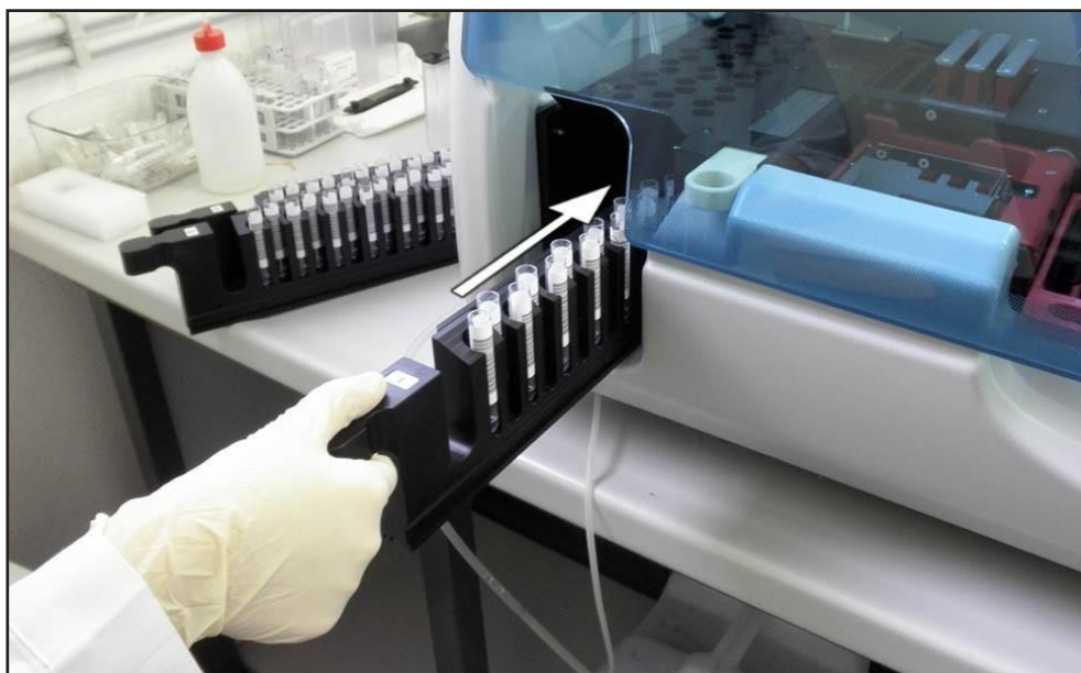
Рис. 9: Размещение штатива держателя для пробирок (только для серии со встроенным пробоотборником)
