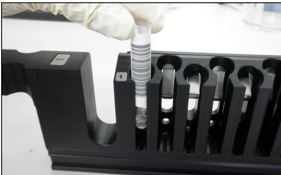
Рис. 8: Размещение пробирок в штативе для пробирок (только для приборов со встроенным пробоотборником)
