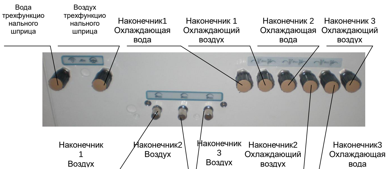
Рис.7 Регулировка давления воды и воздуха
