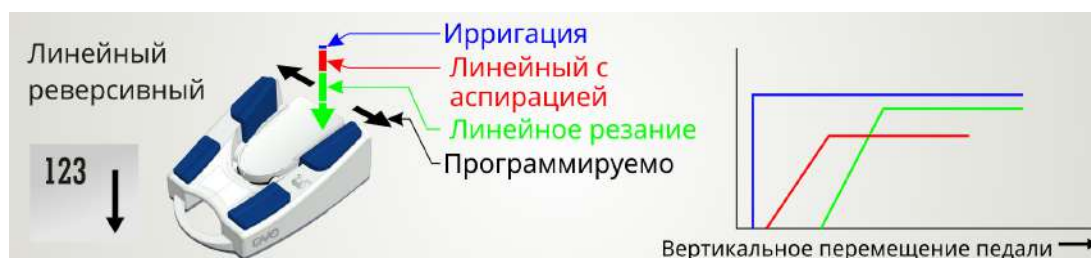
Fig. 100: Режим педали: Линейный реверсивный
