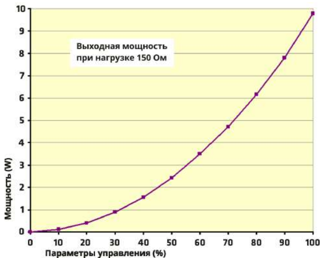
Fig. 105: Диатермия: Выходная мощность в зависимости от настроек управления
