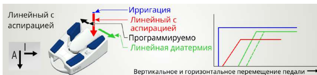
Fig. 109: Режим педали: Диатермия — линейный режим с аспирацией
