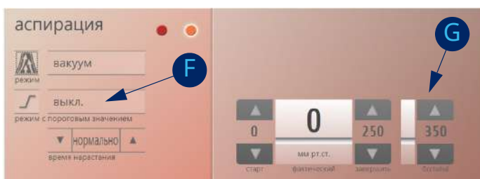
Fig. 78: Управление аспирацией (пороговое значение вакуума)
