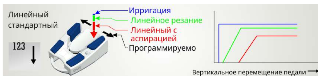
Fig. 99: Режим педали: Линейный стандартный
