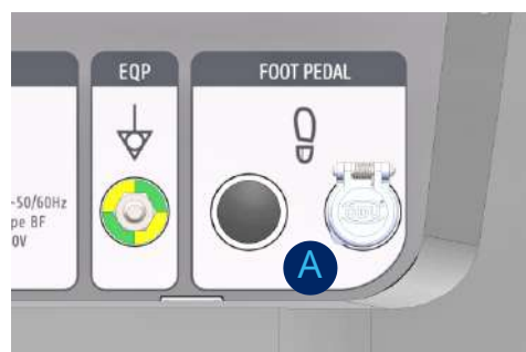
Fig. 45: Проводные подключения педали
