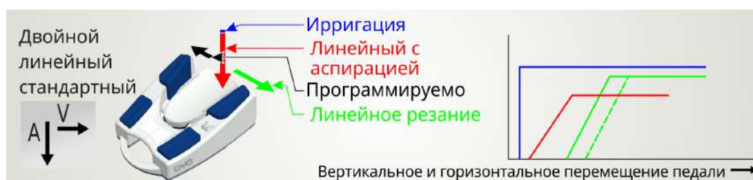
Fig. 101: Режим педали: Двойной линейный стандартный
