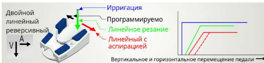
Fig. 102: Режим педали: Двойной линейный реверсивный
