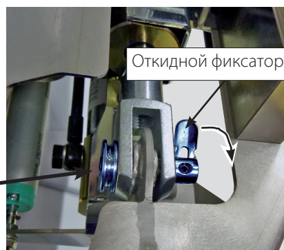
Рис. 13-3 Зафиксированный X-цилиндр Для освобождения болта – потянуть фиксатор
