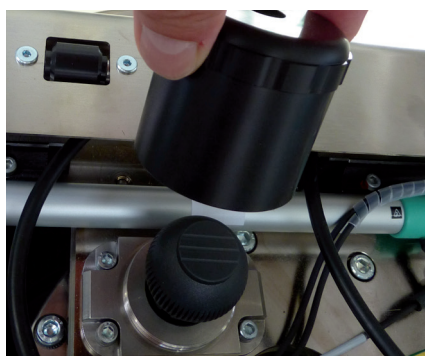
Рис. 13-2 Отвинтить защитный колпачок Потянуть болт
