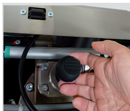
Рис. 13-2 Отвинтить защитный колпачок Потянуть болт
