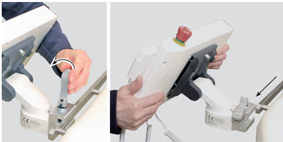
Рис. 4-4 Открыть зажимную планку и сдвинуть держатель со стандартной направляющей
