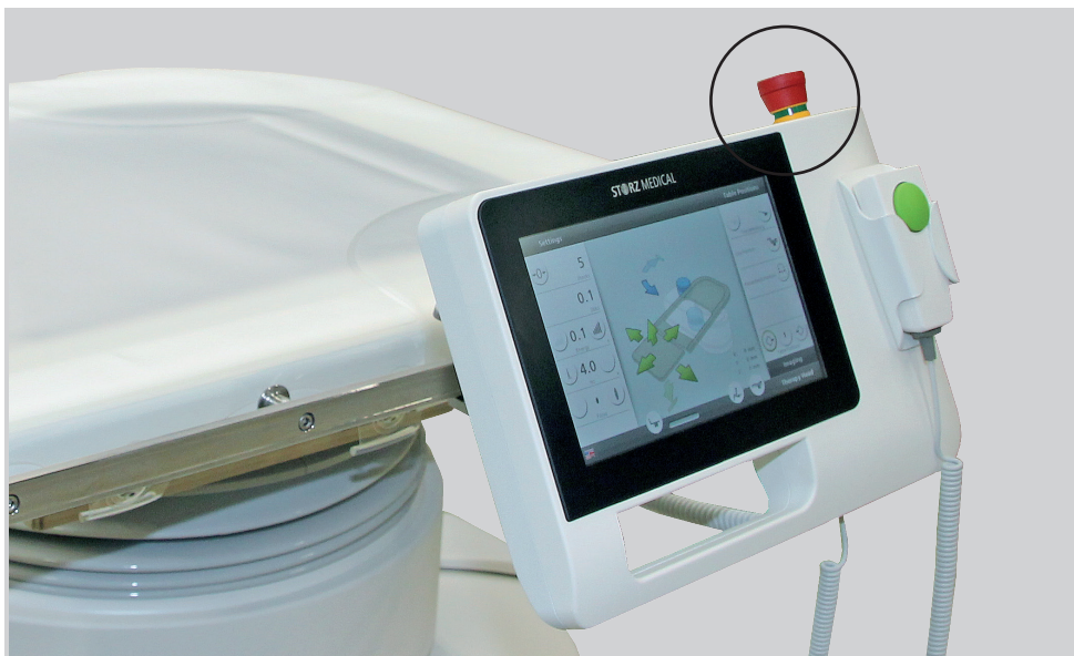
Рис. 4-6 Кнопка аварийного отключения на панели управления
