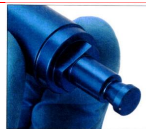
Часть соединения Hudson на перфорационном сверле должна быть вставлена наравне с выемкой
