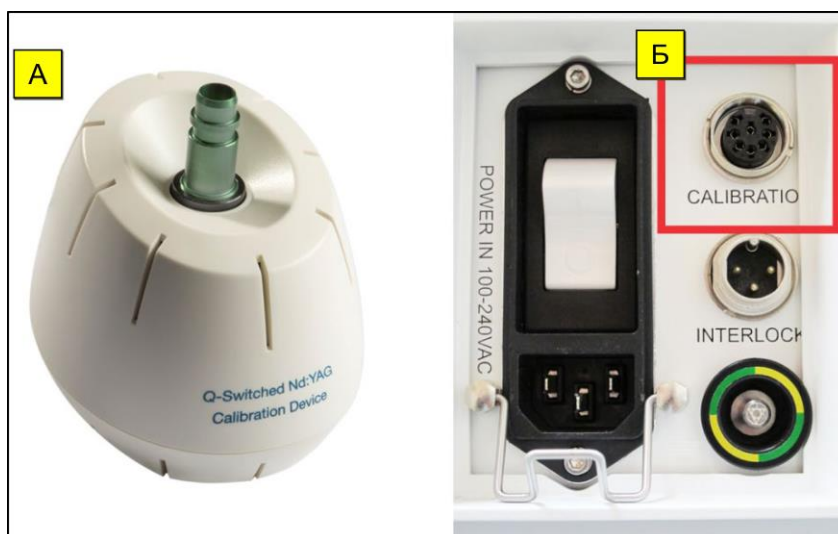
Рисунок 6-14: Подключение устройства для калибровки рукоятки Q-Switched Nd:YAG к соединителю сервисной панели
