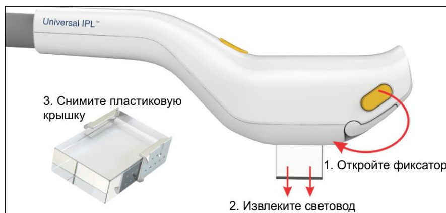
Рисунок 6-2: Извлечение световода SapphireCool из рукоятки Universal IPL
