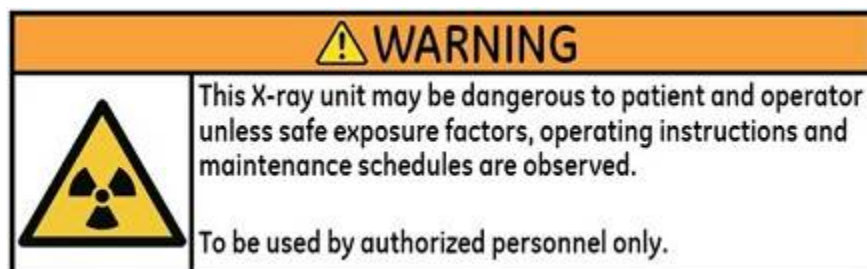
Рисунок 4 Этикетка, расположенная на пульте управления сканированием (см. 21CFR 1020.30 (j))
