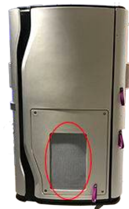
Рисунок 31 Вентиляционные отверстия на гентри системы Revolution™ CT with Apex edition (вид справа)
