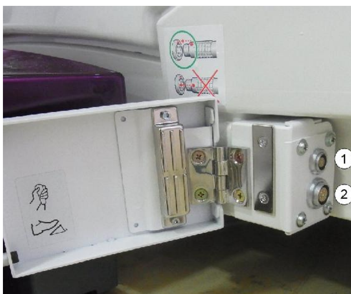
Рисунок 207 Панель доступа, расположенная на лицевой стороне гентри
