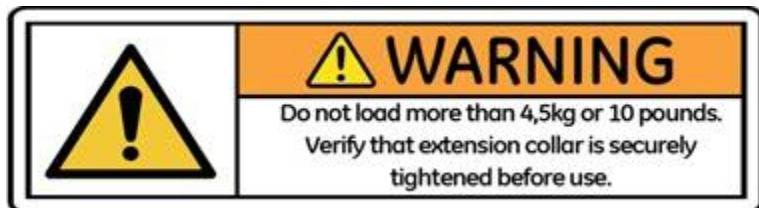
Рисунок 15 Этикетка с предостережением на ножке стойки капельницы
