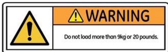
Рисунок 17 Предупреждающая этикетка на ножке лотка стола
