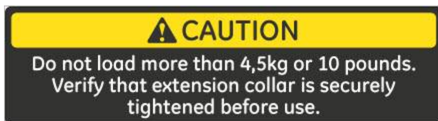
Рисунок 14 Предупреждающая этикетка на ножке стойки капельницы
