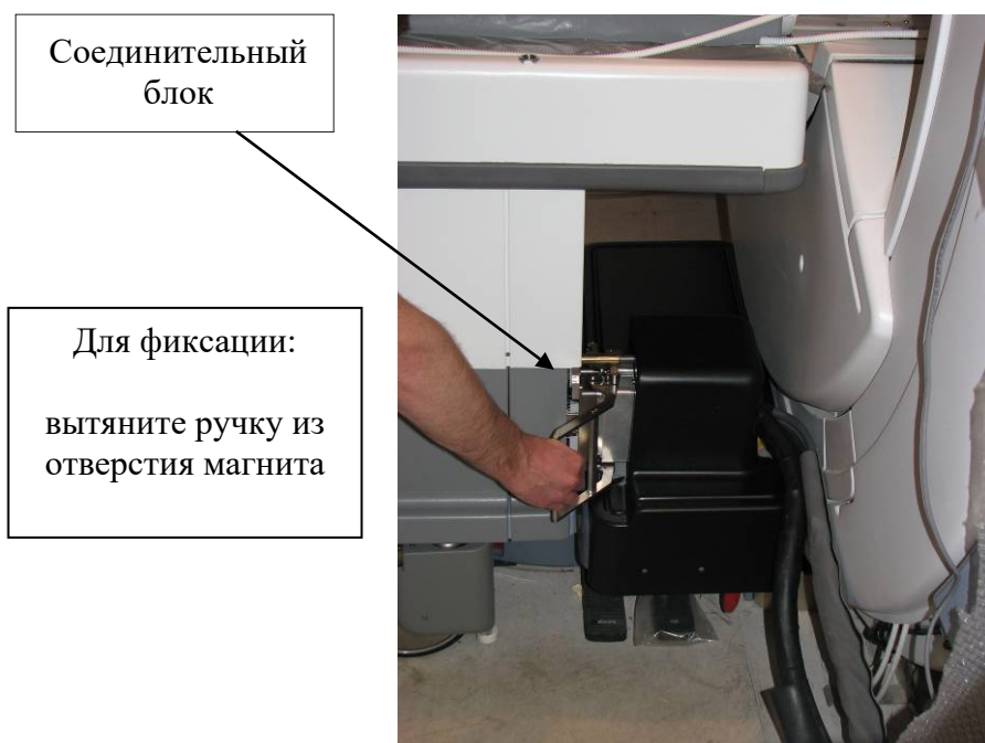
Рисунок 3–1. Подключение стола пациента к МРТ-сканеру в системе ExAblate 2100V1
