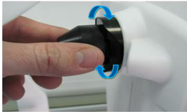
Рисунок 44. Установка адаптера. Поверните для блокировки
