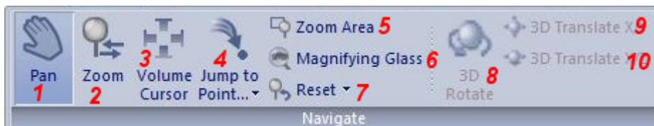
Рис. 112. Вкладка «Tools» (Инструменты): группа «Navigate» (Навигация)
