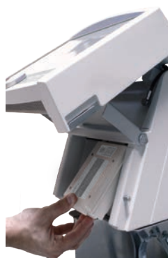
Рисунок 40. Установка аккумуляторных батарей Xenios
