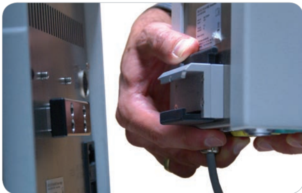
Рисунок 17. Закрепление блока датчиков Xenios на рейке блока питания Xenios
