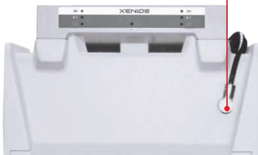
Рисунок 11. Подключение панели управления Xenios к блоку питания Xenios
