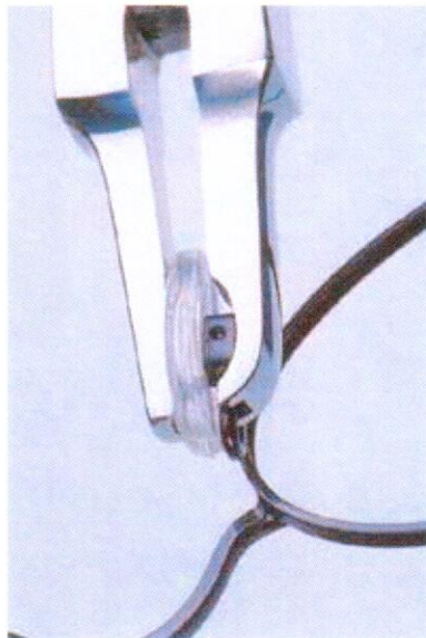
Рис. 9. Выправка носового упора
