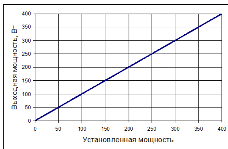
Рисунок А.1 – Зависимость выходной мощности от установленной мощности при номинальной нагрузке
