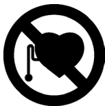
Рис. 1. Знак «Не входить с электрокардиостимуляторами»
