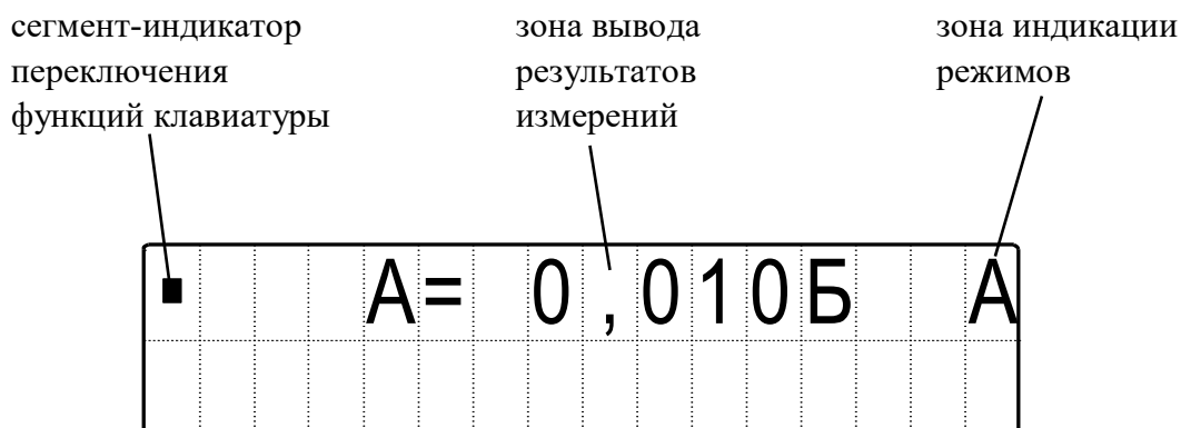
Рис. 2 Внешний вид индикатора
