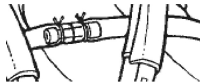
Рисунок 4-37. Разъем для лигатурной фиксации
