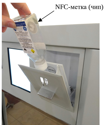
Рисунок 6. Установка нового флакона со стерилизующим средством
