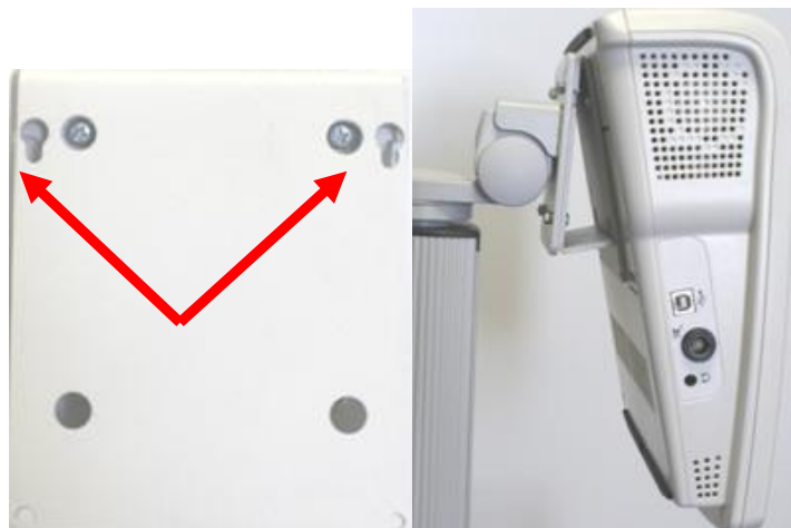
Рисунок 2.3. Установка прибора на передвижной стойке
