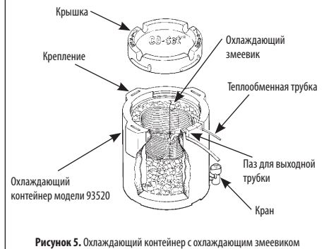
Рисунок 5. Охлаждающий контейнер с охлаждающим змеевиком
