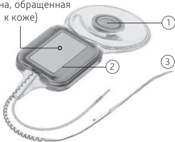
Рисунок 2. Кохлеарный имплант CI512 — сторона, обращенная к коже
