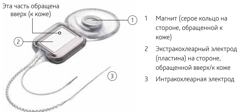
Рисунок 2. Кохлеарный имплант CI522 с электродной решеткой Slim Straight (сторона, обращенная к коже)
