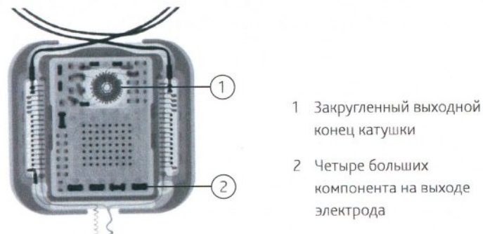
Рис. 28. Простая рентгенограмма импланта серии CI500
