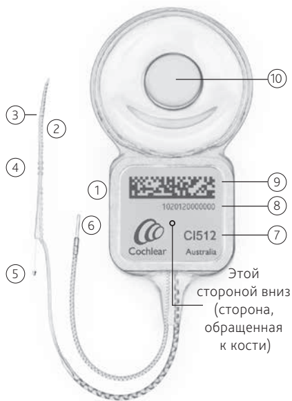
Рисунок 1. Кохлеарный имплант CI512 — сторона, обращенная к кости
