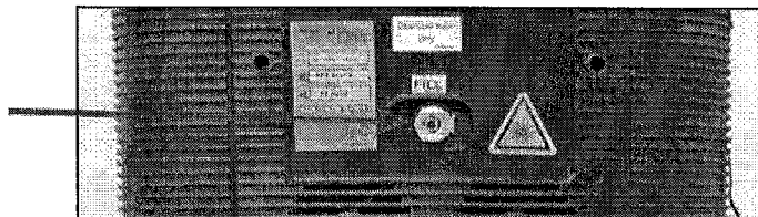
Рисунок 7-3: Порт для заполнения резервуара охлаждающей жидкости на сервисной панели
