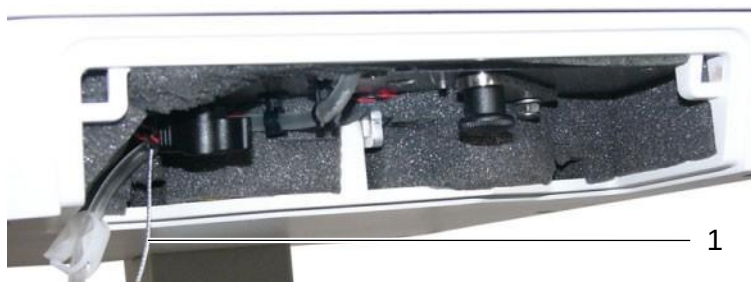
Рис. 14 Механизм аварийного отпирания
