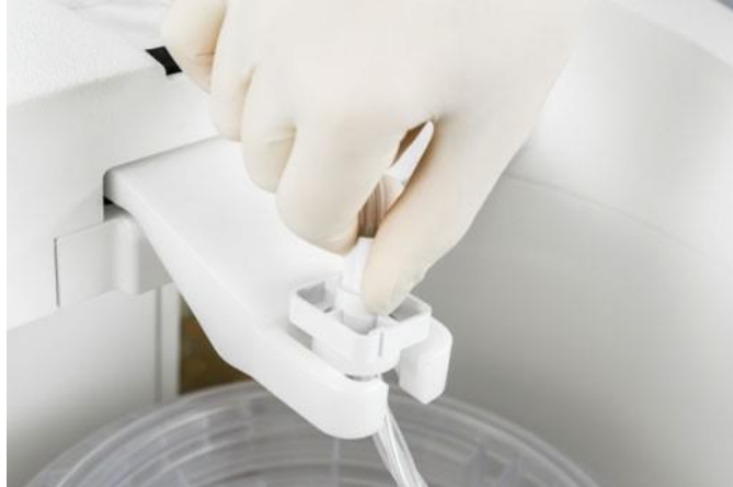
Рис. 29 Установка устройства сопряжения центрифуги
